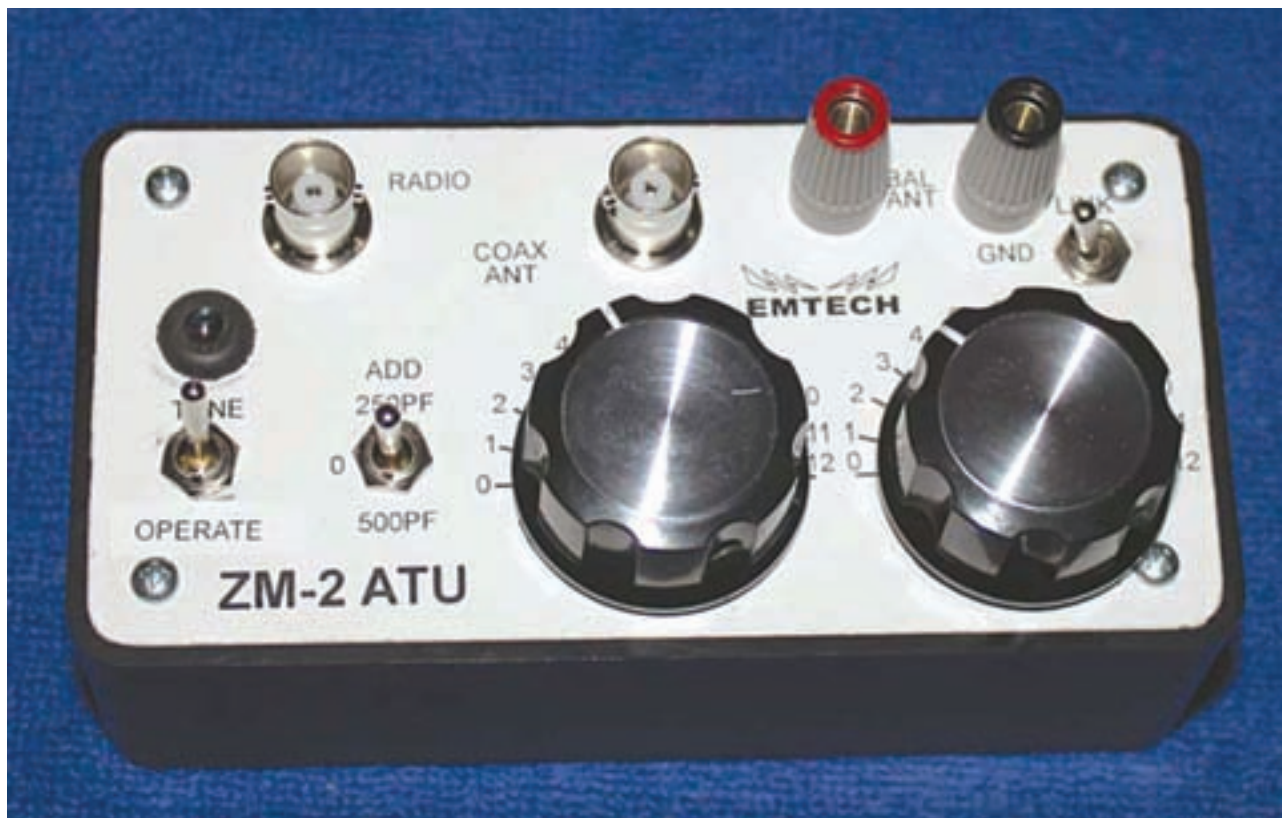
El ZM-2 de Emtech ya completo y montado en la caja suministrada.
