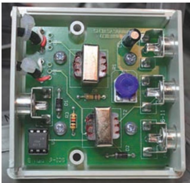
Foto D: La interface de tarjeta de sonido SCI-6 terminada y montada en su caja. Observa los escasos componentes de este kit, lo que lo hacen ideal para principiantes o para el montaje en grupo.
