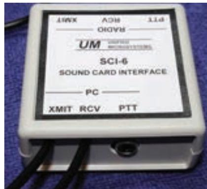
Foto C: La interface de audio SCI-6 lista para ser conectada al ordenador.
