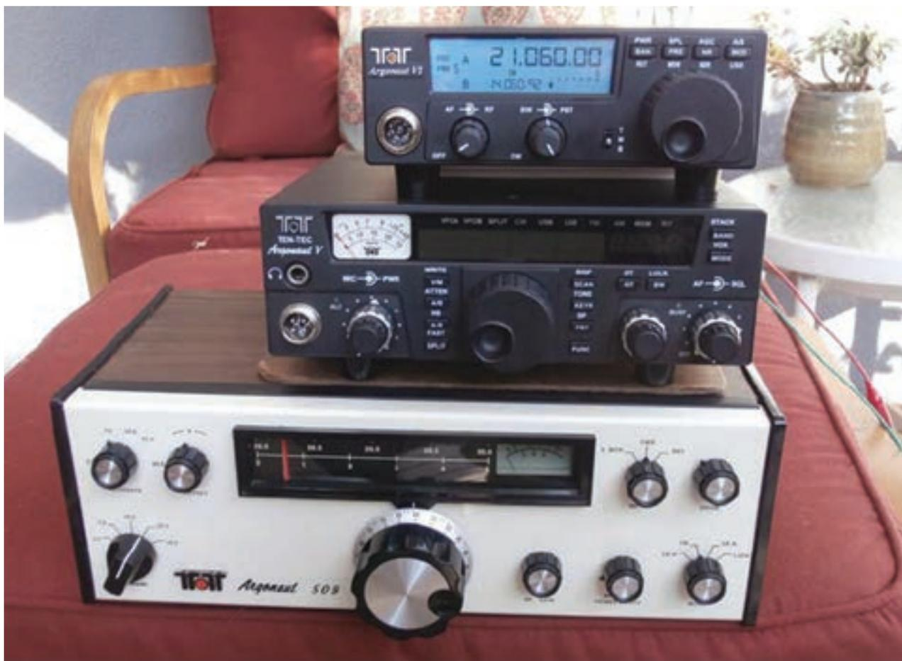
Foto B: Tres generaciones de transceptores Argonaut: arriba, el nuevo Argonaut VI; en medio, el Argonaut V; y abajo, el Argonaut 509.
