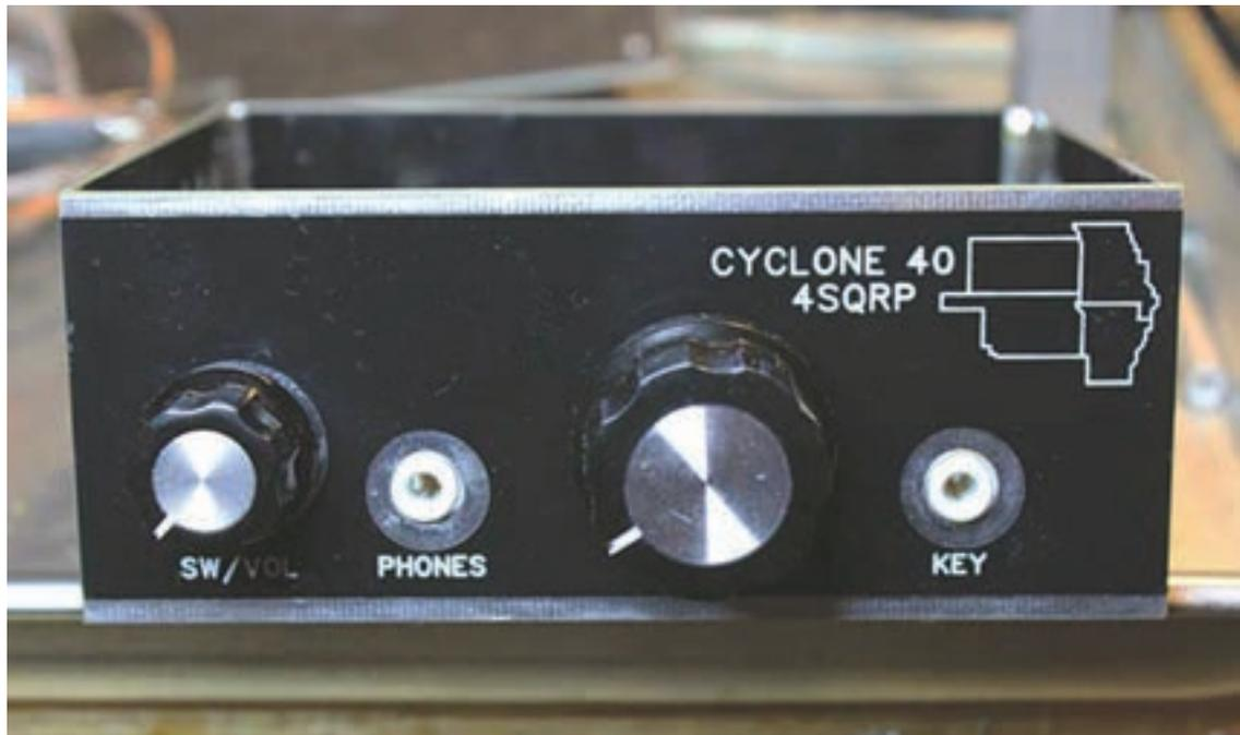
Foto A: El panel frontal del transceptor Cyclone 40 del 4-State QRP Club. Las tapas superior e inferior todavía no han sido colocadas.
