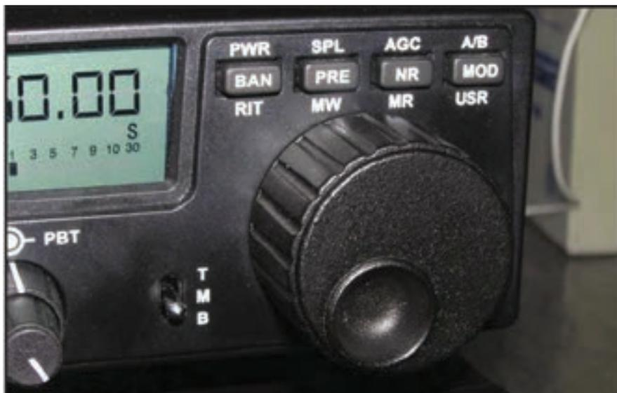
Foto C: Vista ampliada de los cuatro pulsadores multifunción y el conmutador deslizante de tres posiciones.
