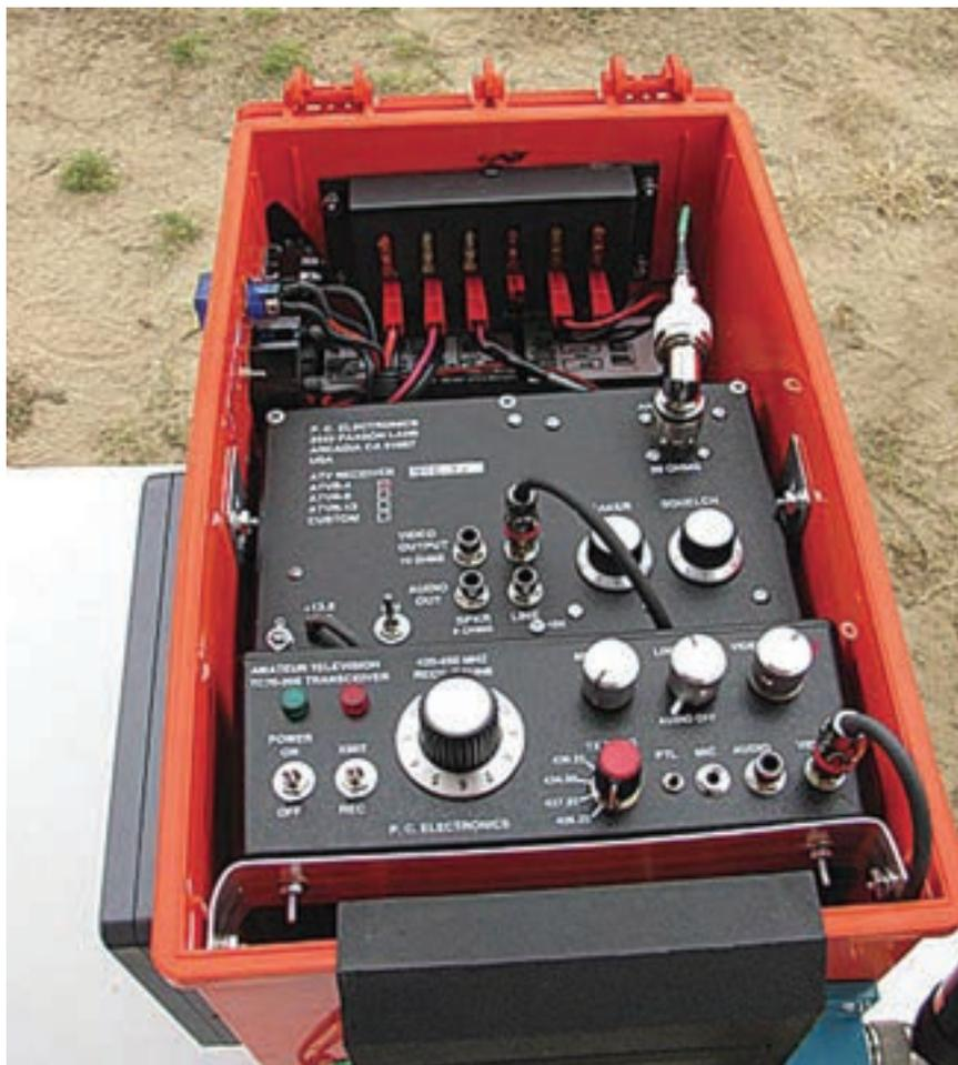
Foto 2: Aquí tienes un equipo portable de ATV montado por el Dr. Steve Garboff, W7GOS, jefe de comunicaciones del RACES (Radio Amateur Civil Emergency System) en Huntington Beach.
