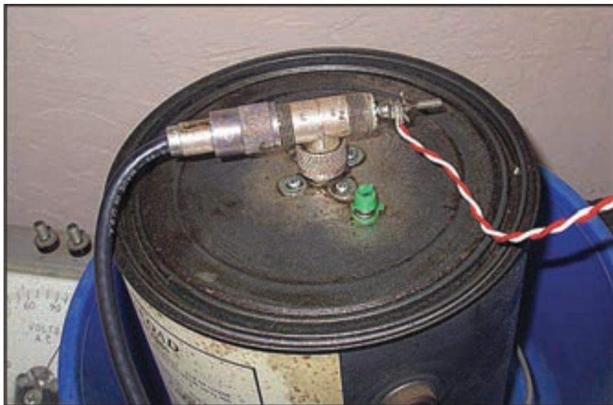
*Foto A: Distribuir tu potencia entre una resistencia de carga y una longitud cualquiera de cable hará feliz a tu transmisor, porque siempre encontrará una carga de 50 ohmios y te permitirá hacer contactos con la potencia residual radiada que surja de tu "antena QRP".*
