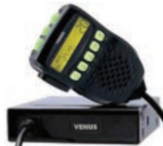
La Lafayette Venus es una emisora de CB en 27 MHz increíblemente pequeña y compacta. Posee todos los controles en el micrófono-altavoz y tiene capacidad para trabajar con subtonos CTCSS en modo FM. En pantalla muestra el número del canal y la frecuencia correspondiente. Posee silenciador automático o manual. El roger-beep es conmutable y la recepción podemos oír a través de sus dos altavoces. Es un aparato multies-tándar que opera en AM o en FM.
