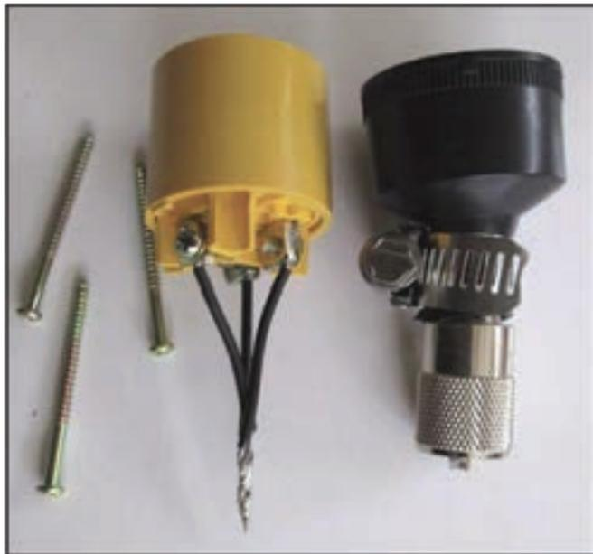
Foto B: Cómo convertir tus luces de Navidad en una antena. Realiza un adaptador uniendo el vivo y el neutro que proceden de las luces y conéctalos al conductor central del conector PL-259 de tu coaxial.
