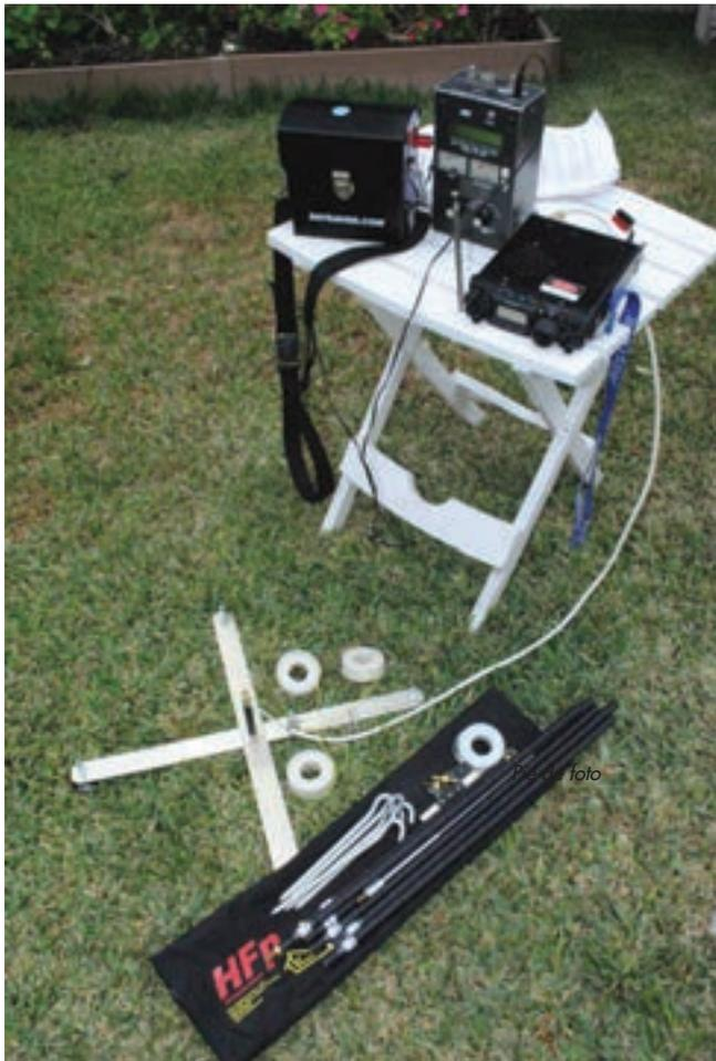
Foto D: La nueva vertical de Ventenna para HF es fácil de desmontar y transportar, facilitando en gran manera la operación en portable.
