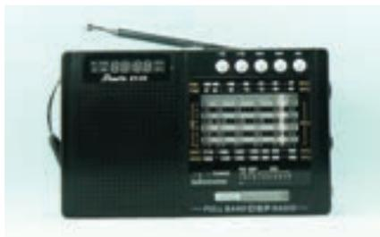
Basada en DSP analógico con función de reproductor de mp3. Similar a los receptores Degen DE321, Degen DE32, Kchivo KK 9803 o el Tecsun R 2010 D, dispone de un mecanismo de ajuste analógico alimentado por un chip DSP SI484X Silabs.
