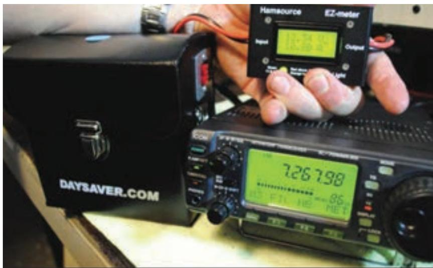
Foto C: Comprobando la tensión de la batería de DaySaver con 100 W de salida y que muestra 12,34 V con una corriente de 10 A.
