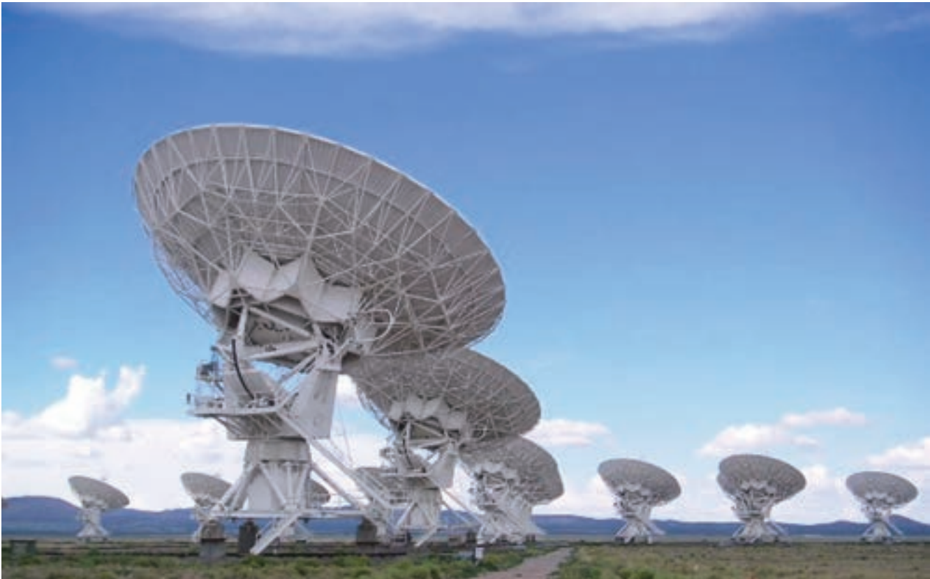
El LADS (Large Aperture Deep Array 11) del Instituto Lauton es una agrupación de radiotelescopios coordinados para interferometría dentro del Very Large Array de Socorro, Nuevo México (Foto cedida por Hajor, Wikimedia Commons).
