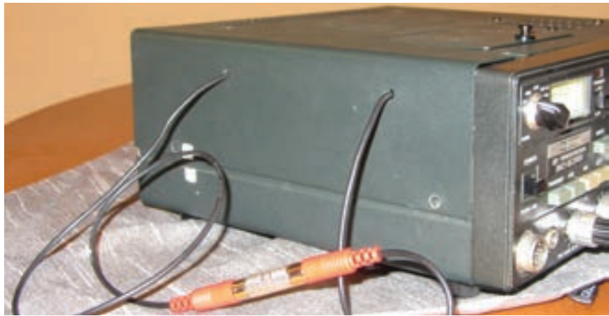
Fotos B y C. Cableado a través de orificios existentes en la cubierta, y conector doble hembra para cuando la modificación no sea empleada.
