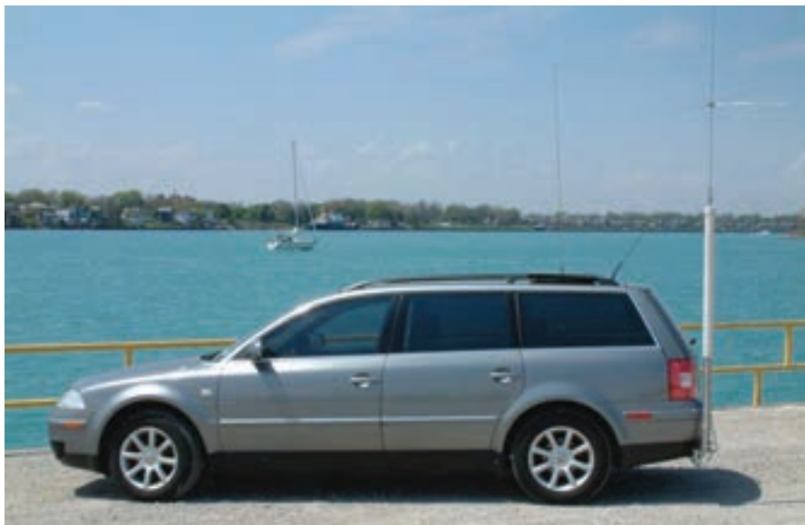
Foto A: Aquí está mi coche actual con la antena TABA (Tuneable All Band Antenna) montada en la parte posterior (Fotos cedidas por el autor).
