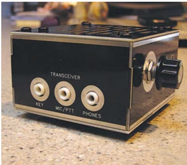
Foto F: Vista ampliada de la interface 4S-Link, concretamente de los conectores que van hacia el transceptor.
