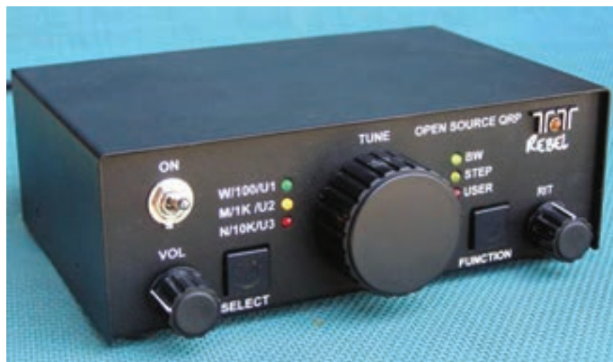
Foto C: El Rebelde de Ten-Tec es una novedad en equipos de radio con una placa del PC Arduino programable a tu gusto, aunque es un transceptor QRP ya montado. Véase el texto para más detalles.
