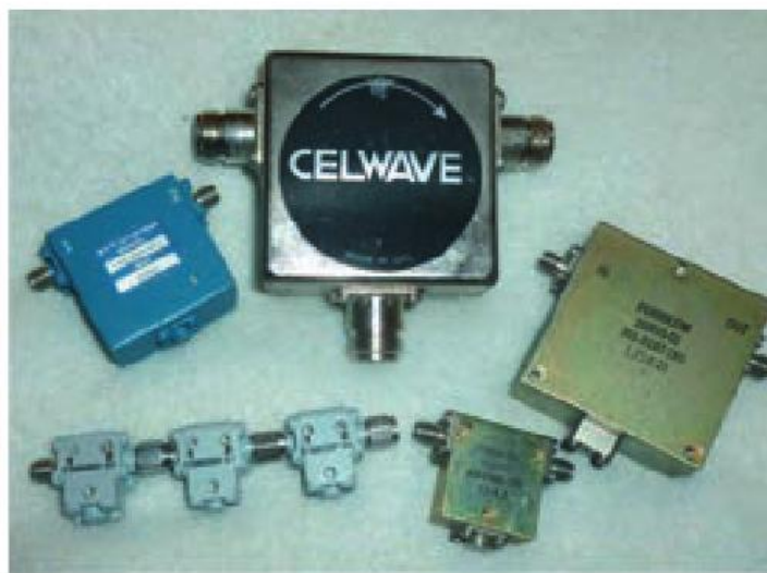
Foto C: Los circuladores de ferrita permiten que la RF fluya en una sola dirección, pero están afectados por el ruido producido por la saturación de los núcleos si son sobreexcitados.
