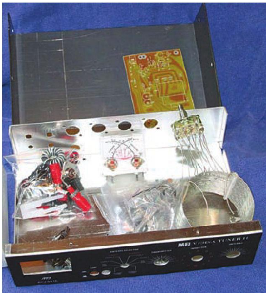
El kit del acoplador MFJ-941EK listo para montar
