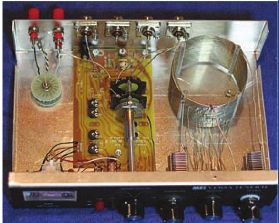
Vista interior del MFJ-491EK ya terminado.
