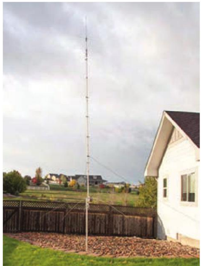
Jim Reise, AD1C, de Brighton, Colorado, ha trabajado 280 países desde Agosto de 2008 utilizando 100 W y una G5RV para 40 metros (interior) y esta vertical High-Gain AV640.
