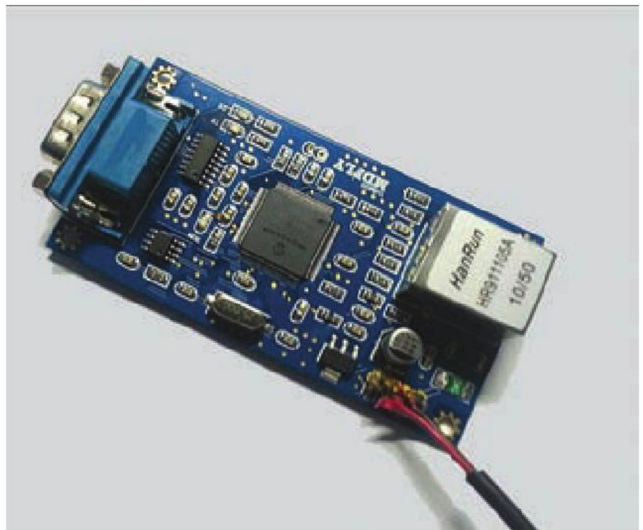
Foto A: El adaptador serie-Ethernet CV9600. Observa el puerto serie con conector DB9 en el lado izquierdo y el conector RJ45 Ethernet en el lado derecho.
