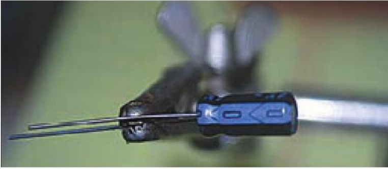
Foto D: Un condensador no polarizado (compárese con el electrolítico de la foto E).
