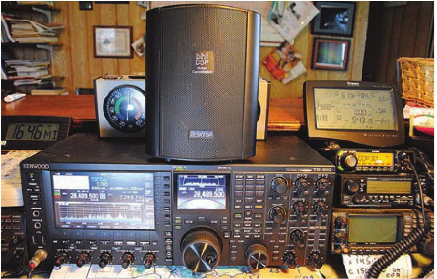
Foto A: El altavoz amplificado Desktop con DSP de Bhi colocado encima del transceptor TS-990 del autor. Puesto que el 990 dispone de su propio DSP, en esta instalación el procesado digital del Desktop ha sido desconectado (foto cedida por el autor).
