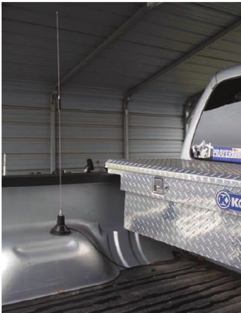
Foto 1: La simple instalación de la antena magnética doble banda en el paso de rueda.
