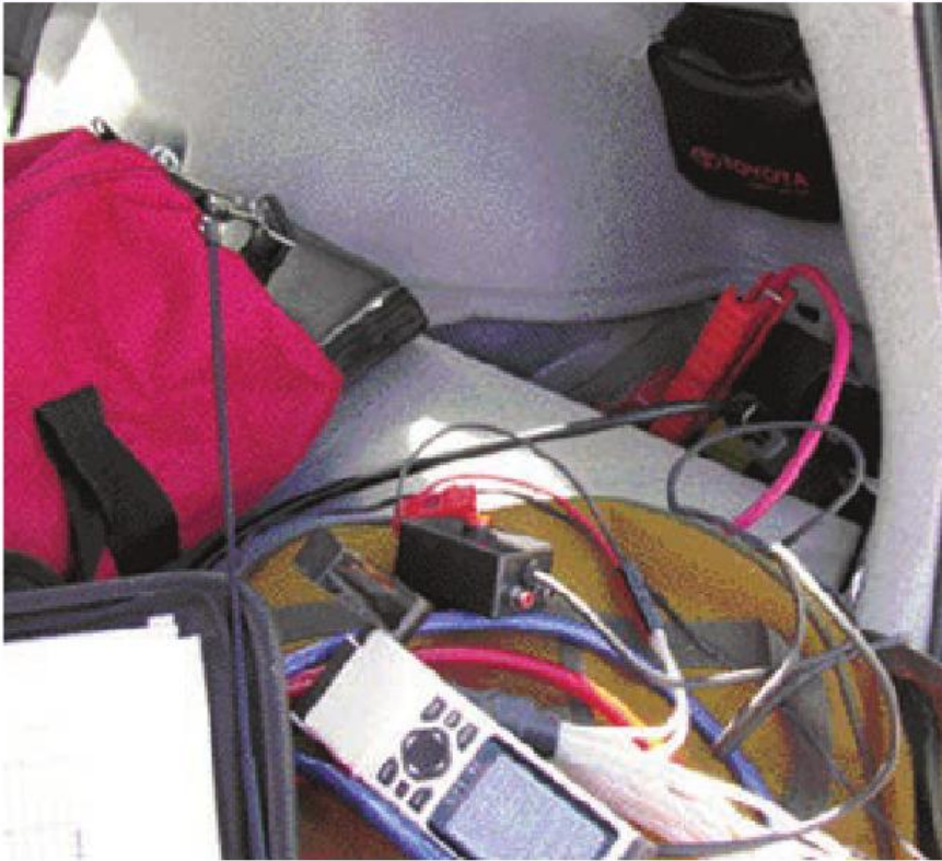
Foto D: Puedes ver una gran pinza conectada a la batería en el lado derecho de la foto. Este no es un buen modo de sacar la alimentación de un vehículo y mejorar esta conexión es mi primer objetivo en mi lista de mejoras futuras.
