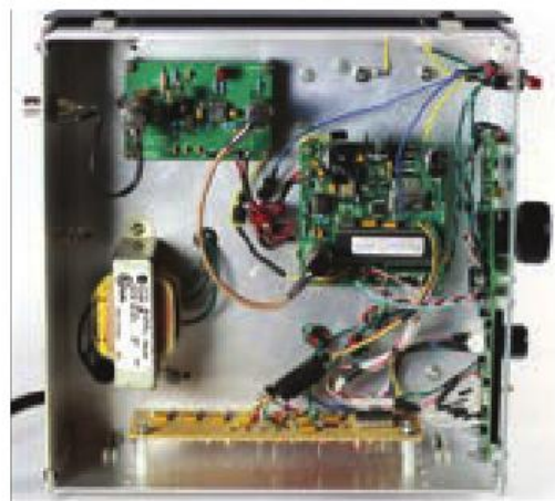
Foto D: Vista superior del DDS-VFO. Observa el transformador para la fuente de alimentación incluida, a diferencia del HG-10 que obtiene su alimentación de la tensión de filamentos del transmisor.
