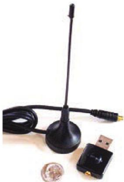
Figura 1: El dongle USB y su antena ya modificada. La moneda sirve para que apreciéis la escala. Éste en particular recibía entre 52 y 2202 MHz, con un hueco entre 1102 y 1234 MHz. La antenita solo sirve para aprovechar el conector que encaja en la entrada de antena del dongle.
