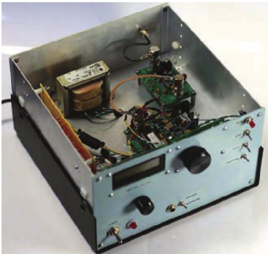
Foto A: El DDS-VFO (versión 2) que pretende reemplazar al clásico (pero gran patinador) VFO HG-10 de Heathkit. También proporciona tensiones y conmutaciones para utilizarlo con varios receptores (Fotos cedidas por Joe Havrilla, N3DHD).
