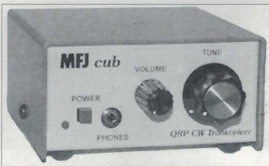
Una de las últimas presentaciones de MFJ es la serie Cub, que incorpora componentes de montaje superficial.
