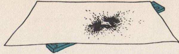
4. Sobre una superficie plana coloca a ambos imanes, uno a continuación de otro, de manera que el polo norte del uno quede a un centímetro de distancia del polo sur del otro imán. Sobre los imanes coloca una hoja de papel blanco y espolvorea a lo largo de aquéllos unas limaduras de hierro.
