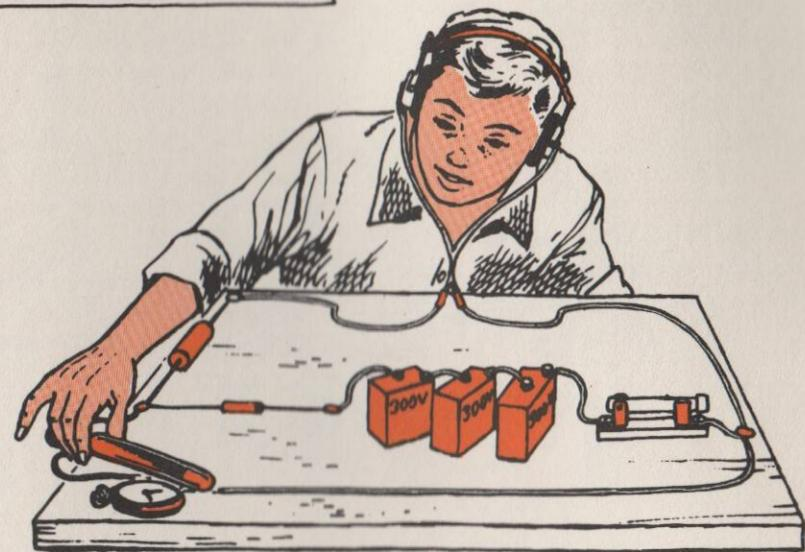
Monta los materiales en la forma que se indica en el esquema. Procura comprobar que el interruptor está en la posición de abierto hasta que todas las conexiones no han sido hechas. Recubre con la cinta aislante todas las partes en que el conductor queda desnudo de su aislamiento.
