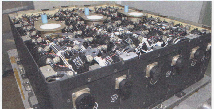
Geöffnetes Akkuomodul mit insgesamt 66 Zellen
