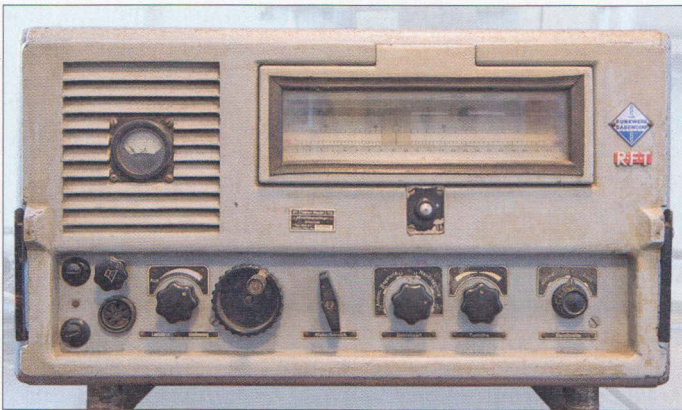
Bild 7: Draufsicht auf den Geräteeinschub der ersten Version des Dabendorf mit Oktalröhren
