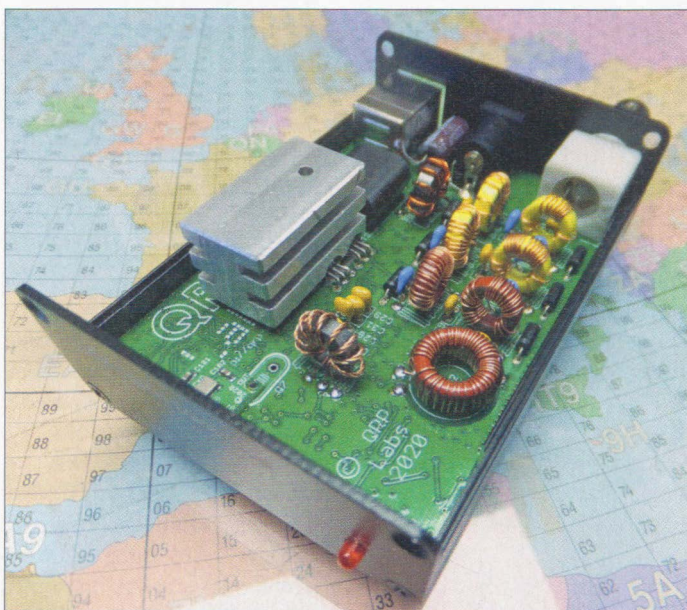
Bild 2: Die SMD-Bauteile sind auf der Platine bereits vorbestückt.
