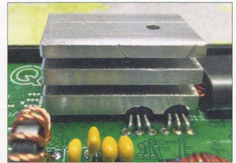
Bild 7: Dieser selbst angefertigte Kühlkörper gewährleistet den zuverlässigen Sendebetrieb.
