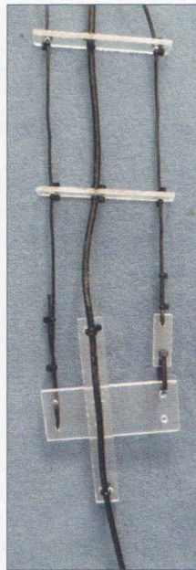
Bild 11: Unterer Abstandhalter; für die recht kurze Abspannung des 12-m-Strahlers (rechts) reicht ein Kabelbinder.
