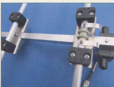
Detailansicht einer Yagi-Antenne mit der neu entwickelten symmetrischen Speisung
