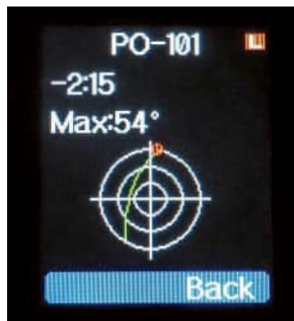
Bild 8: Sat-Ansicht 1/3 mit Satellitenname sowie grafischer Darstellung von Richtung und Elevation
