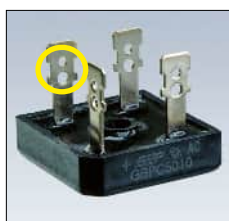
Bild 5: Neuer Brückengleichrichter vom Typ GBPC5010 mit Löchern für M2-Schrauben
