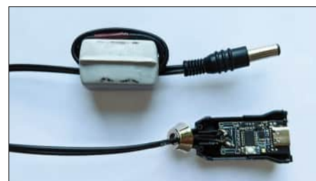
Bild 4: Industriell hergestelltes Triggerkabel mit eingebautem PD-Triggermodul COM-ZY12PDN-ST
