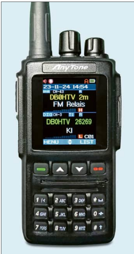
Bild 1: Das Anytone AT-D168UV ist mit einem farbigen Display ausgerüstet, das eine Vielzahl an Informationen bereitstellt.
