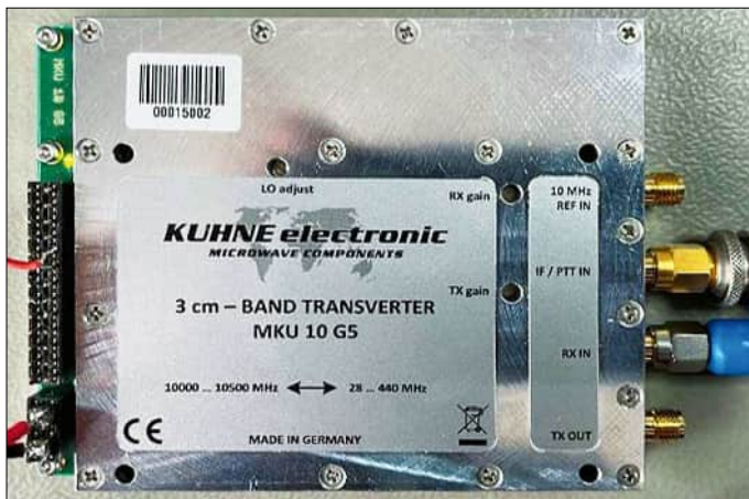
Bild 1: Der 10-GHz-Transverter MKU 10 G5 hat ein gefrästes Aluminiumgehäuse, an dessen beiden Schmalseiten sich die SMA-Steckverbinder und eine Anschlussleiste befinden. Letztere dient u. a. zur Zuführung der Versorgungsspannung und zur Konfiguration des Geräts.
