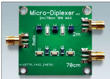
Bild 1: Diplexermodul mit 2-m-Tiefpass- und 70-cm-Hochpassfilter; die Anschlüsse sind als SMA-Buchsen ausgeführt.
