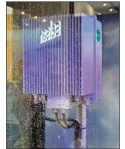
Outdoor-Repeater und Basisstation unter der Dusche
