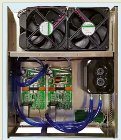
Blick von oben in das geöffnete Gehäuse der 2-m-Endstufe mit den beiden Axiallüftern und der Wasserkühlung
