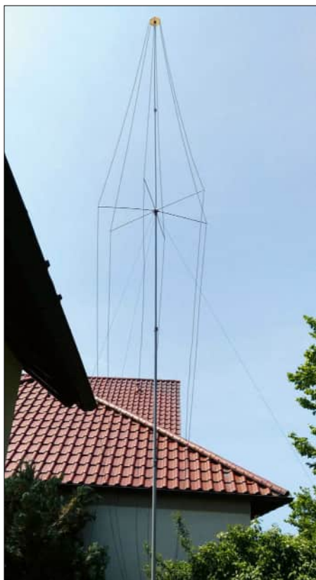
Bild 1: Selbst gebaute, am „Bauch“ abgespannte Reusenantenne Fotos: DL2NI
