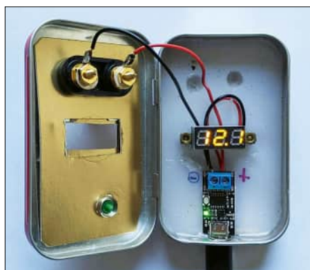
Bild 3: Innenansicht mit Trigger- und Mini-Digitalvoltmeter-Modul Fotos: DM4TG
