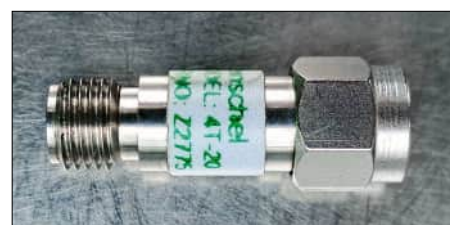
Bild 3: Mit diesem hochwertigen, bis 18 GHz spezifizierten Dämpfungsglied vom Typ Weinschel 4T-20 wurde die Eingangsanpassung signifikant verbessert.
