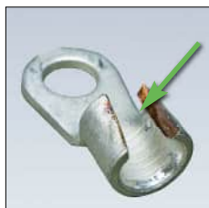
Bild 7: Ringkabelschuh mit modifizierter Kabelaufnahme
