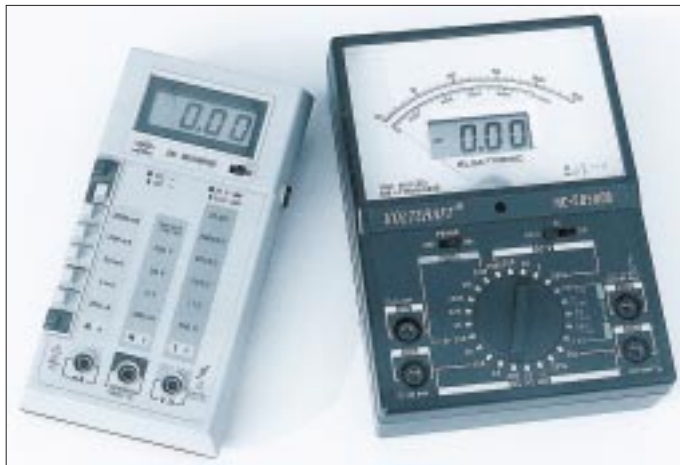
Bild 1: Digitale Multimeter (hier eines der älteren Generation und ein moderneres) zeigen zwar anfangs noch gemeinsam 0 V an, später dann aber an derselben Spannung meist unterschiedliche Werte. Da hilft nur eines: neu kalibrieren!
