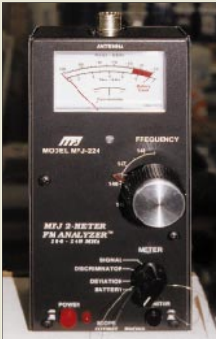
Der 2-m-FM-Analysator MFJ-224 mißt den Hub und mit 60 dB Anzeigeumfang den Pegel eines 2-m-FM-Signals.
