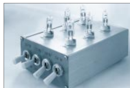
Bild 2: Zum Aufbau der Lampenlast wird ein handelsübliches Aluminiumgehäuse verwendet.
