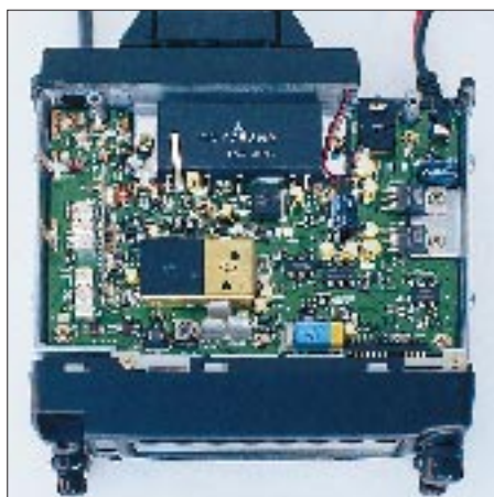
Innenansicht die zweite: Hier der Blick auf die geöffnete Geräteunterseite mit dem kompletten 70-cm-Teil.
