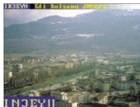
Bilder 12 und 13: Diese beiden Bilder zeigen, was sich mit einer wirklich einfachen Empfangsanlage, bestehend aus einem Direktmischempfänger DC 2000 (Bild 8), Komparator-Modem Sempel-2 [1] und MSCAN2.11 im 80-m-Band erreichen läßt.
