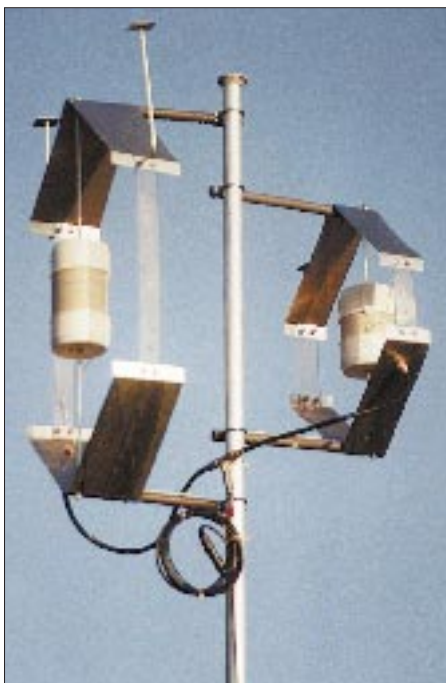
Die zusammen montierten und gespeisten beiden Isotron-Antennen für 40 m und 80 m
