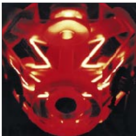
Micro-Lasergyro mit 12 cm Strahllänge Foto: SFENA
