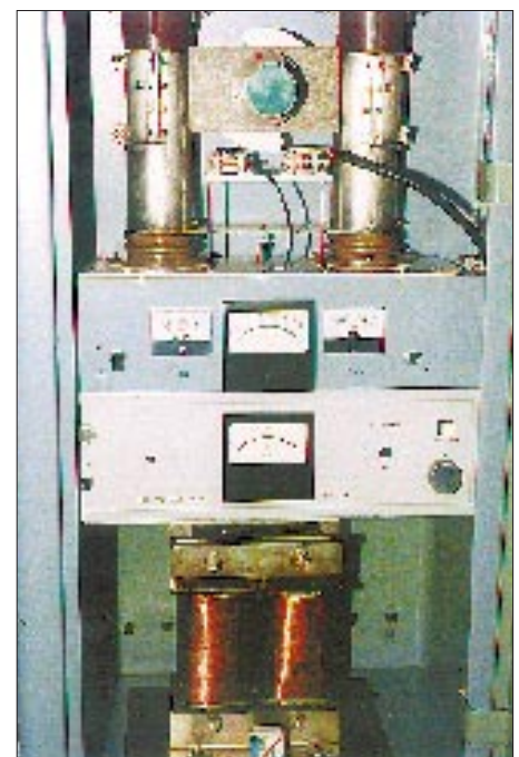
Blick in die mit zwei sowjetischen Röhren GI 7 B bestückte 2-m-Endstufe von DL1DUR Fotos: DL1DUR
