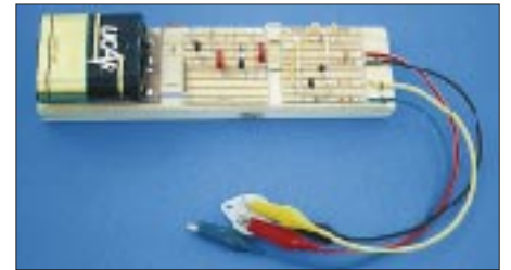
Auf einem Holzbrettchen aufgebauter Dioden/Transistor-Tester mit Flachbatterie zur Stromversorgung Fotos: DL1BLV
