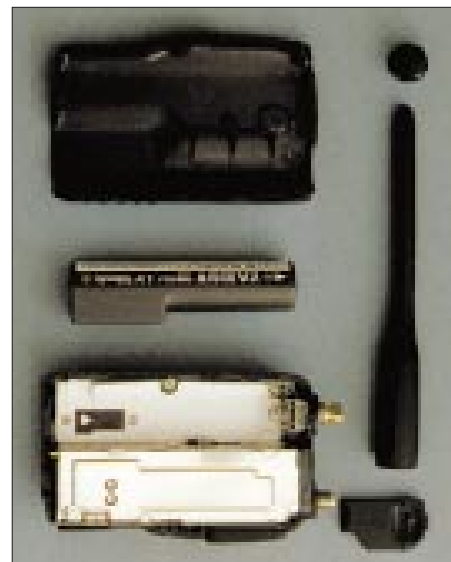
Das zerlegte VX-1R. In der Mitte ist der Lithium-Ionen-Akku, der etwas größer als eine Mignonzelle ist. Fotos: FA
