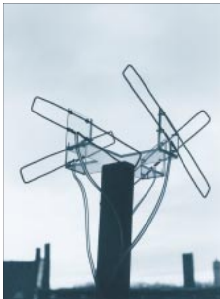
Bild 6: Die fertig aufgebaute 70-cm-Lindenblad. Die Elementträger und das Montagekreuz sind aus Plexiglas gefertigt.
