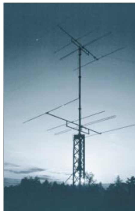
Bild 5: Die 4-über-4-Element-Gruppe für 50 MHz im Abendlicht Foto: DF9CY
