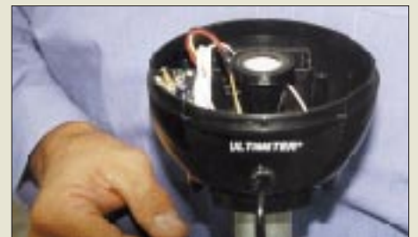
Der neue Regensensor der von der Fa. Hummel vertriebenen Davis-Wetterstation mißt unmittelbar die durchtretende Wassermenge.
