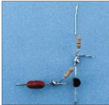
Einfach, aber nicht besonders haltbar: Schaltung, die „fliegend“ aufgebaut wurde
