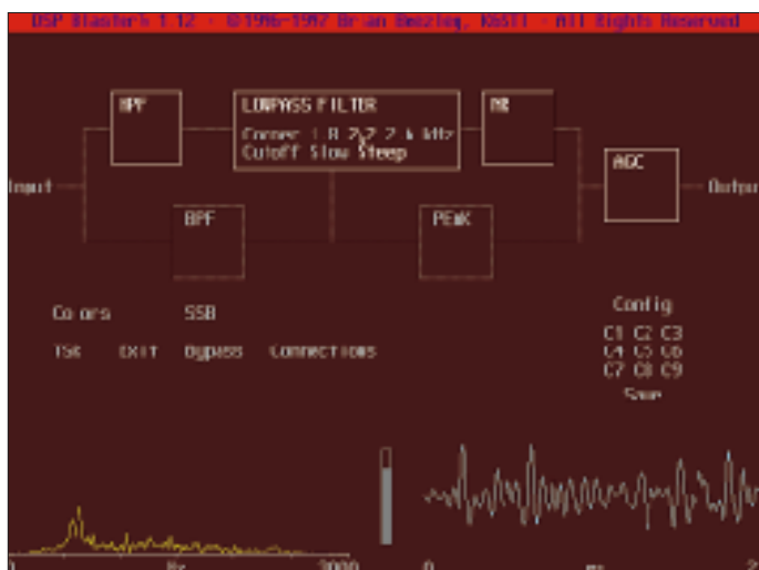
Bild 2: SSB-Signal mit aktiviertem Tief- und Hochpaßfilter sowie Geräuschreduktion
