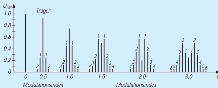
Bild 7: Normiert-modifizierte Darstellung des Frequenzspektrums bei der Frequenzmodulation für die relative Pegel der Spektrallinien von Träger und Seitenfrequenzen
