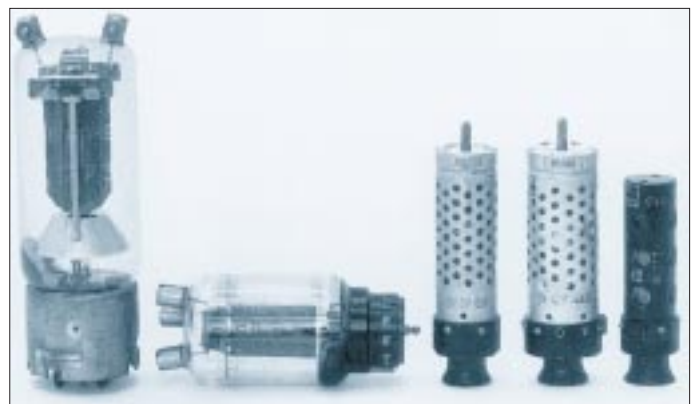
Mittelgroße Wehrmachtsröhren RL 12 P35, RL 12 P50 und „Lockenwickler“-RV 2 P800, RV 12 P4000 und RL 2T2 (von links)
