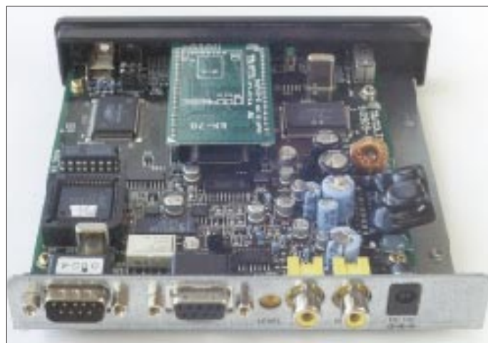
Bild 3: Blick in das Gerät. Links sitzt hinter dem Quarz der DSP-IC in einer PLCC-Fassung. Die Leiterplatte für den zweiten Bildspeicher ist über der ersten montiert. Stiftleisten verbinden die Zusatzplatine EM-70 mit dem Motherboard. Rechts ragt der Gleichspannungswandler über den Rand der Hauptleiterplatte.
