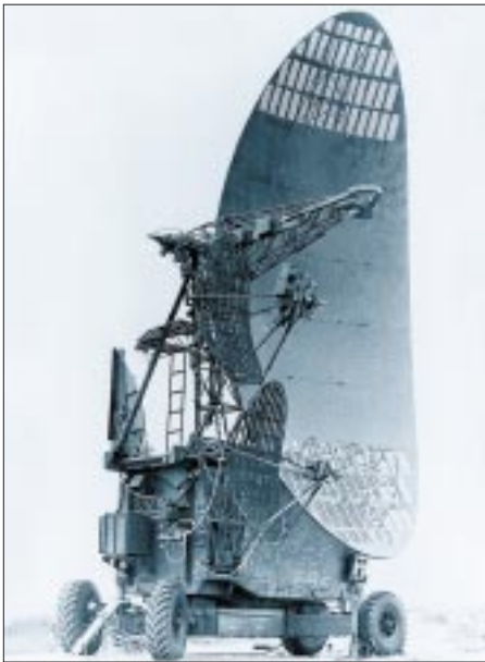
Sende/Empfangs-Kabine des Funkhöhenfinders PRW-17 mit Hauptantenne und mehreren Antennen zur Unterdrückung von Funkmeßstörungen
