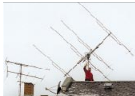
Die vier 11-Element-DL6WU-Langyagis, mit denen Jürgen, DL1DUR aus JO70KV, MS und EME macht Foto: DL1DUR
