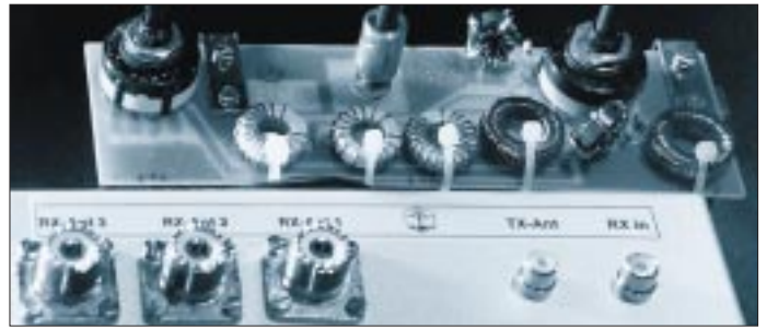
Bild 4: Der BCC-Preselektor mit herausgeklappter Leiterplatte
