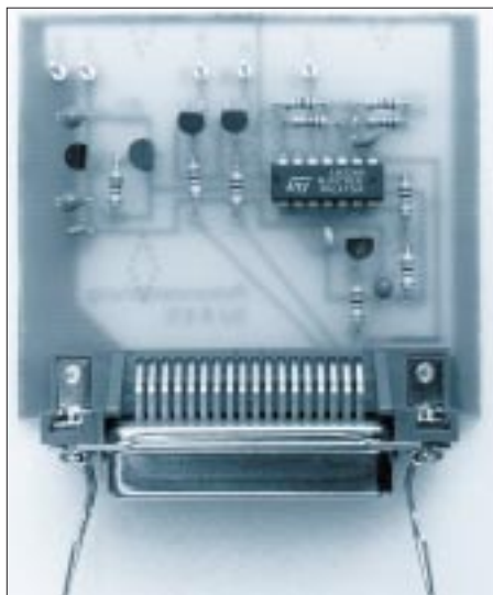
Bild 4: Ansicht der Platine für die Antennen- fernsteuerung
