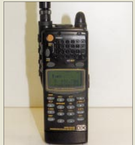
Alinco DJ-X10 ist ein Breitband-Scanner für 100 kHz bis 2000 MHz mit 1200 Speicherplätzen, dessen Channel Scope bis zu 40 Kanäle gleichzeitig überwacht und im Display darstellt.
