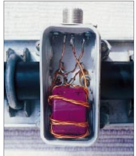
Bild 5: Anschlußdose mit Balun und Koaxialbuchse
