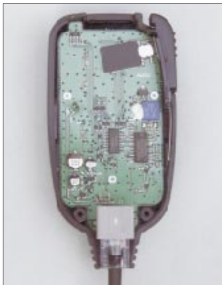
Im zum Lieferumfang gehörenden Mikrophon verbirgt sich schon ein halber Computer, der alle Steuerungsvorgänge ermöglicht.
