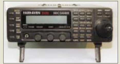
Der ebenfalls computersteuerbare Fairhaven RD 500 empfängt von 40 kHz bis 40 MHz und kann mit stattlichen max. 57 000 Speicherplätzen on board aufwarten.
