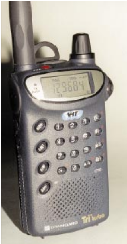
Frontansicht des C510. Sende-, Zweitfunktions- und Beleuchtungstaste verfügen über einen deutlichen Druckpunkt. Die winzige rote Taste auf der Oberseite dient zum Ein- und Ausschalten. Fehlbedienung ausgeschlossen!
