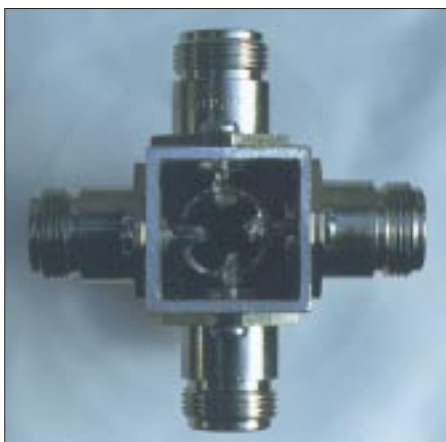
Bild 9: Blick in einen Vierfachverteiler
