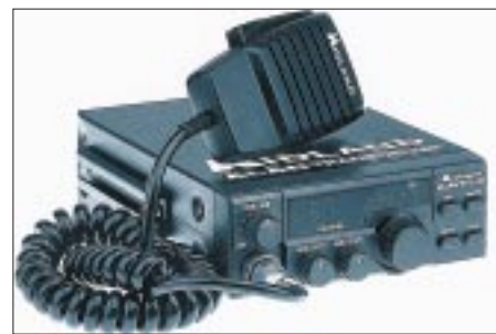
Bild 2: CB-Funkgeräte bringen zwar bei guten Ausbreitungsbedingungen ausreichende Feldstärken, haben aber oft für diesen Einsatz zu unempfindliche Empfangsteile.
