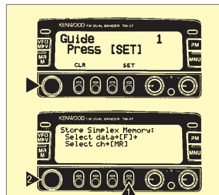
Die integrierte Benutzerführung wird im Set-Menü aufgerufen; anschließend kann man bis zu vierzeilige Texttafeln mit kurzgefaßten Erklärungen durchblättern.
