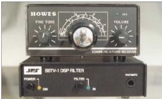
Bild 8: Außenansicht des KW-Empfängers DC 2000 der englischen Firma Howes. Mit etwas Eigenbau-Zubehör (z. B. Antennentuner, und wie hier NF-Filter) läßt sich dieses Gerät kostengünstig aufwerten.
