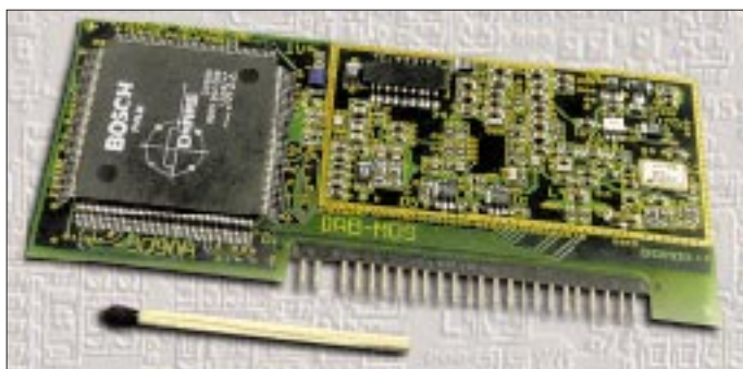
Doppelte Streichholzlänge – das zur Zeit kleinste verfügbare DAB-Modul
