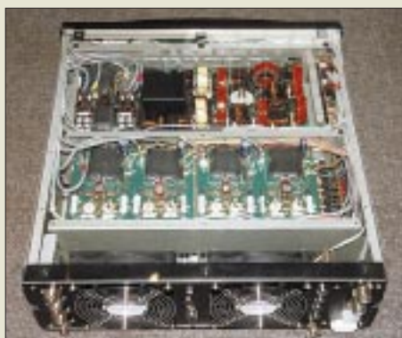
Blick ins Innenleben der mit vier Gegentakt-MOSFET-Modulen aufgebauten 1-KW-PA VL-1000 von Yaesu
