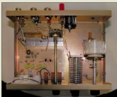
Ein interessantes Detail des Antennentuners VC 300 DLP von Vecronics ist die Induktivität nach dem Prinzip des Ringkern-Stelltransformators.
