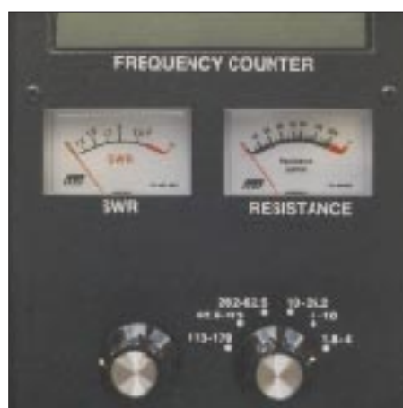
Bild 4: MFJ-259-Teilansicht mit Frequenzeinstellung, Bereichsschalter, Anzeigeelementen und Display
