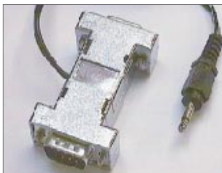
Bild 2: Der Steckerkonverter „Microscan“ von CombiTech. Das Einstiegsgerät von PA3GPY ist nur für Empfangszwecke geeignet (z. B. für SWLs).
