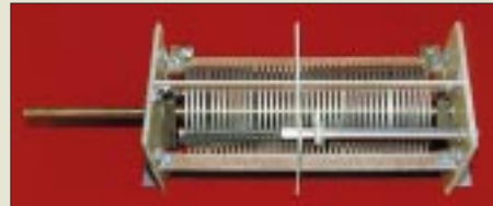
Der neue Versatuner II, MFJ-969, enthält eine originelle Rollspule, den Eigenresonanz-Killer, bei der außen ein schwenkbarer Kontakt den „offenen“ Spulenteil zur Vermeidung von Eigenresonanzen kurzschließt.
