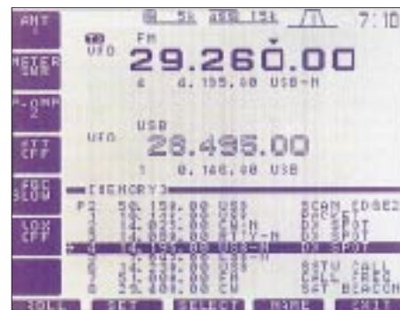
Bild 7: Das hochauflösende Display kann bei der Auflistung der Speicherplätze die Daten von neun Speichern inklusive zehnstelliger alphanumerischer Bezeichnungen zugleich darstellen.
