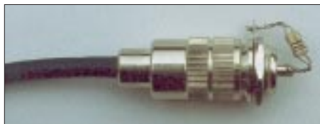
Bild 15: Selbstgebauter Abschlußwiderstand 50 Ω zum Messen der Anpassung
