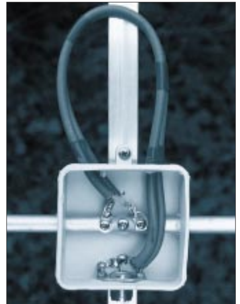
Bild 17: Die Anschlußdose mit gestrecktem Dipol als Strahlerelement
