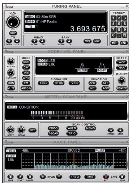
Bild 7: Bei dieser Bedienoberfläche sind die Einstellparameter auf vier Einzelfelder verteilt, die sich je nach Bedarf einzeln oder gemeinsam aufrufen lassen.
