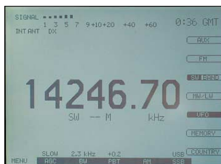
Bild 5: Das Punktmatrix-LC-Display zeigt neben der Frequenz etliche weitere Empfangsparameter, darunter am oberen Rand die relative Signalstärke.
