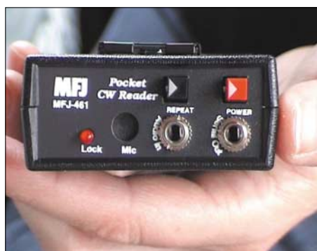
Bild 4: An der Gerätestirnseite befinden sich der Ein-/Ausmacher für das Gerät sowie der Taster REPEAT; ferner die Klinkenbuchse für den externen NF-Signaleingang und eine zur Textanzeige auf einem Computer.
