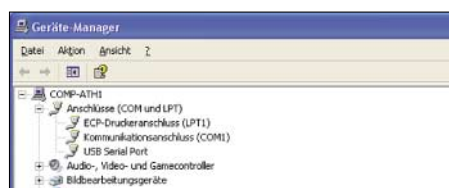
Bild 10: Über Eigenschaften lässt sich im Geräte-Manager die COM-Portnummer anzeigen.
