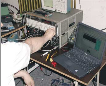
Bild 6: Die beiden Signalgeneratoren zur Messung des Großsignalverhaltens
