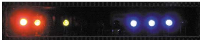
Bild 5: LEDs zeigen auf der Frontseite Betriebszustände (links) und Signalstärke (rechts).
