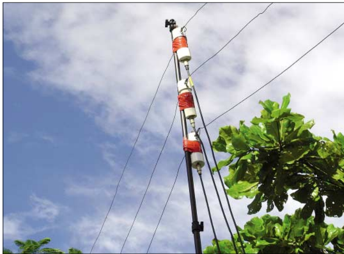
Simplel, jedoch recht effektiv: die eingesetzten Monoband-Dipole
