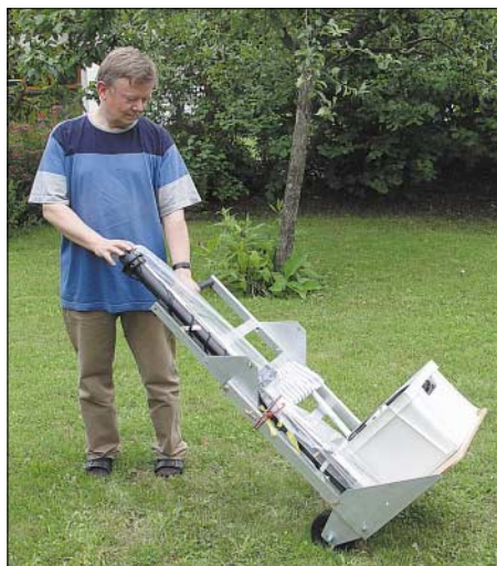
Bild 1: Eine komplette Station für den Fieldday: Die klappbare Transportkarre trägt zunächst Funkgerät, Zubehör und Antenne ...
