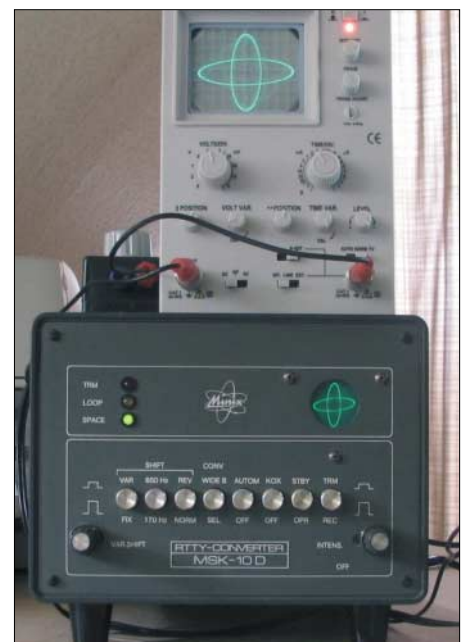
Bild 4: Unten der MINIX-Konverter mit der 3-cm-Oszillografenröhre, darüber zur Kontrolle eine Oszillografenanzeige. Die Abstimmung ist richtig, wenn X- und Y-Achse der Ellipsen senkrecht aufeinanderstehen. Schaltbilder einer Oszillografenanzeige und des DJ6HP-Konverters findet man in [8]. Der Konverter wurde auf die neuen AFSK-Töne abgeglichen. Fotos: DC9ZP
