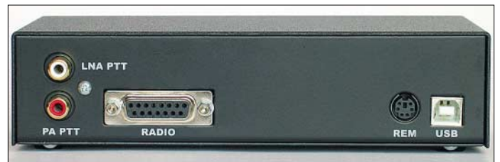
Blick aufs rückwärtige Anschlussfeld
