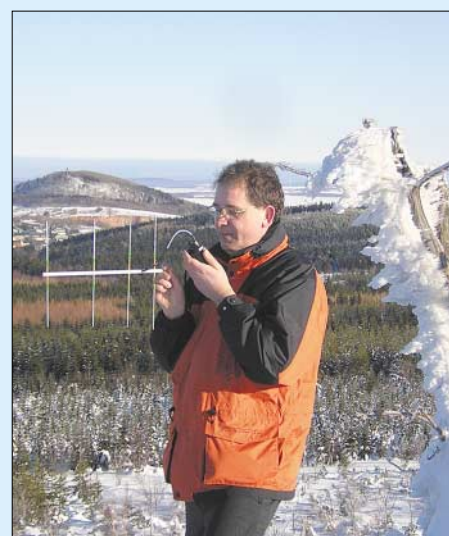
Bild 12: Durch Einsatz einer kleinen Yagi, die abzüglich Kabel- und Steckerverlusten noch einen Antennengewinn von G_{\text{Ant, isotrop}} = 5 auf dem 70-cm-Band aufweist, werden aus den 2 W Sendeleistung des Handfunksprechers 10 W EIRP. Fotos: DJ5AM
