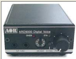
Das Modem ARD-9000 von AOR ermöglicht digitale Sprach- und SSTV-Übertragung ohne Eingriff ins Funkgerät.
