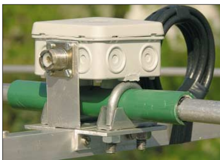
Bild 4: Strahlermittelstück mit aufgerollter Speisedrossel
