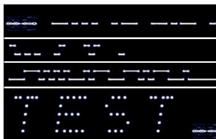
Bild 14: Argo -Screenshots verschiedener Betriebsarten (v. o. n. u.): „Bake“ in normaler Telegrafie, in FSK-Telegrafie, in DFSK-Telegrafie sowie „Test“ im Bildmodus MT-Hell
