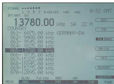
Bild 8: 1200 weitere Speicherplätze ordnen Stationsdaten nach Ländern, hier die Frequenzen der Deutschen Welle.
