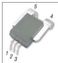
Bild 5: Ansicht und Pinbelegung des Stromsensors
