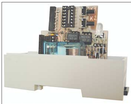
Bild 1: Um den Berührungsschutz zu gewährleisten, sollte ein Leergehäuse verwendet werden, in das sich Grund- und Modulplatine sowie das 230-V-Relais einbauen lassen.
