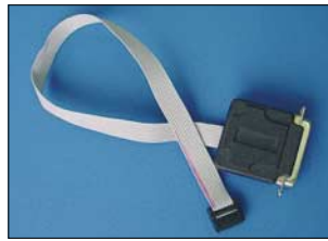
Bild 8: Programmieradapter im Sub-D25-Steckergehäuse Fotos: DK1KQ
