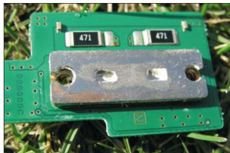
Bild 1: Detailaufnahme des Kühlblocks mit den eingelöteten Transistoren
