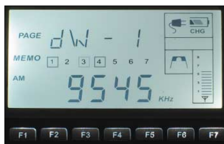
Bild 2: Der E5 speichert 700 Empfangsfrequenzen, verteilt auf 100 alphanumerisch benennbaren Speicherseiten. Dank Hintergrundbeleuchtung von Display und Tasten lässt sich der E5 auch im Dunkeln bedienen.
