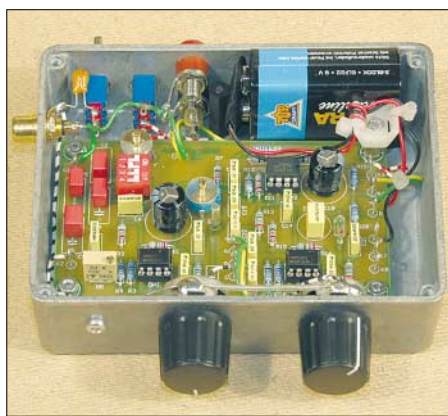
Bild 30: Ansicht des kompakten Messempfängers für die Ortung mittels DCF77 Fotos: DG9WF
