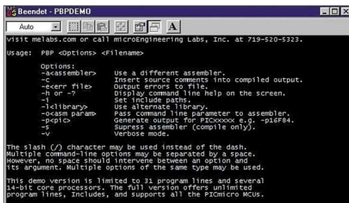
Bild 4: Im Startfenster der Demoversion von PICBASIC Pro werden alle notwendigen Parameter angezeigt.
