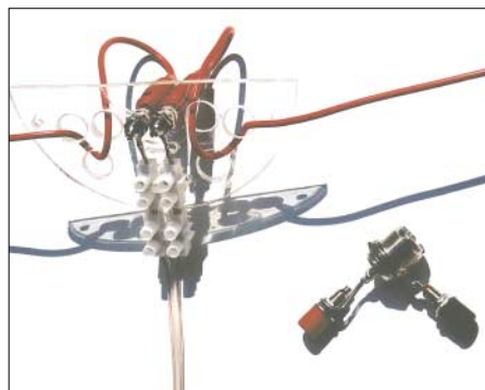
Bild 2: Symmetrische und unsymmetrische Einspeisung
