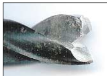
Bild 2: Ein Holzbohrer mit herausgebrochenem Zentrierdorn dient als Fräser für die Lötstützpunkte.
