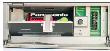
Bild 6: Eine Klappe auf der Frontseite verbirgt das Batteriefach für vier Monozellen. Dort sind auch ein Kontraststeller fürs Display und die Taste Reset zum Neustart der Gerätesoftware zugänglich.
