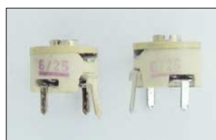
Auch Keramikkörper lassen sich mit den Pinseln wieder aufpolieren.
