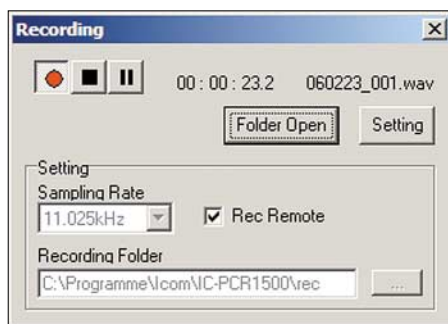
Bild 8: Der integrierte Digitalrecorder zeichnet NF-Signale im WAV-Datenformat manuell per Mausclick oder automatisch bei geöffneter Rauschsperrung auf.
