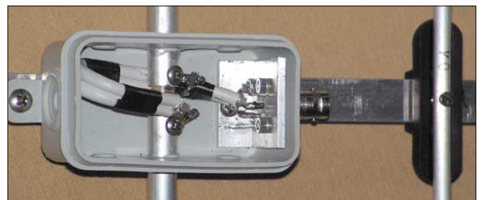
Bild 2: Innenansicht der Strahlerdose bei einer 70-cm-Yagi
