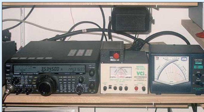
Bild 3: Stationsaufbau für KW und UKW; das Wattmeter in der Mitte überwacht die Aussendungen auf UKW, das rechte die auf der Kurzwelle.
