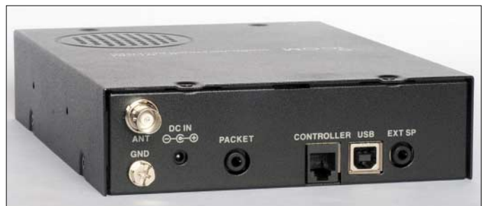
Bild 2: Blick aufs Anschlussfeld. Die Kommunikation zwischen Empfänger und PC läuft über eine USB-Schnittstelle.
