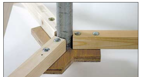
Bild 5: Die untere Trägerplatte des Stativs dient als Auflage für den Mast.
