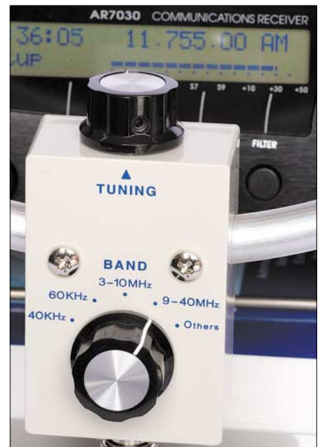
Bild 2: Bandschalter und Tuning-Regler bringen die LA380 in Resonanz.
