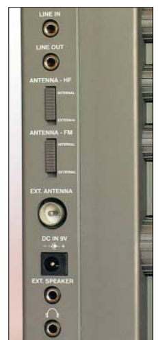
Bild 2: Auf der linken Gehäusesseite liegen das gut bestückte Anschlussfeld und zwei Antennenschalter getrennt nach LMK und UKW.
