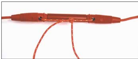
Bild 1: Verbindung der Elemente mittels Büschelsteckern und Doppelkupplung
