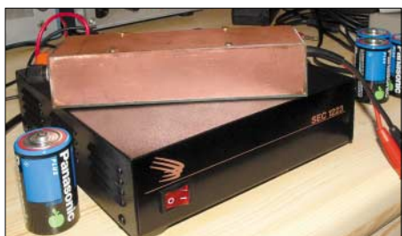
Bild 1: Selbst einfache externe Filter mit Ferritringkernen helfen bei Störungen durch Schaltnetzteile.
