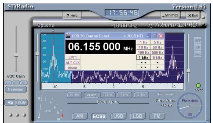
Bild 2: Steuer- und Demodulatorprogramm G8JCFSDR
