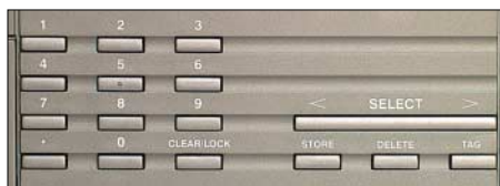
Bild 4: Frequenzen lassen sich per Zehner-tastatur direkt eingeben.
