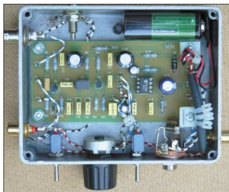
Bild 13: Innenaufbau des für die Messungen verwendeten Sfericsempfängers
