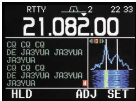
So zeigt sich das Display bei Empfang von RTTY-Signalen; die vielfach geforderte Uhr gibt es freilich auch in anderen Modi.
