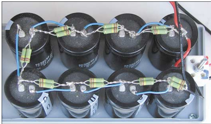
Bild 4: Bank mit acht Elektrolytkondensatoren zu 330 µF/450 V und den jeweils paarweise parallelgeschalteten, für den Leckstromausgleich verantwortlichen Metalloxidwiderständen von 220 kΩ
