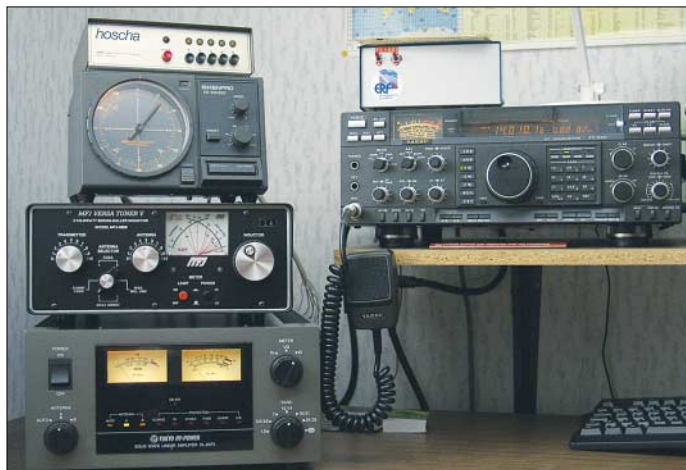
Bild 2: Klein, aber fein – Mit den geringsten Maßen fällt die Linear-Endstufe HL-2KFX in optischer Hinsicht kaum auf und passt fast überall hin.
