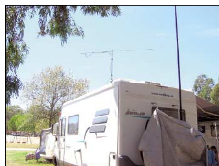
Wie viele andere DXpeditionäre arbeitete auch SV/OE6IWG/p mit einer Neunelement-Tonna.
