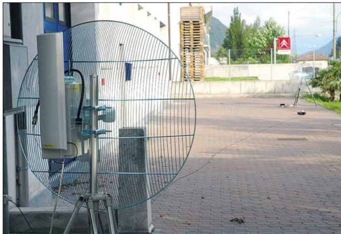
Bild 2: Konventionelle Geräte dienen als Basis für die Hotspots. In den Plastikkästen sind die Module für die Spannungsversorgung via Ethernet untergebracht.
