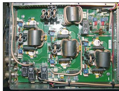
Bild 2: Unter der Haube: Der eigentliche HF-Teil besteht aus drei parallelgeschalteten Gegentaktendstufen.
