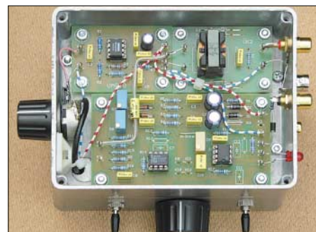
Bild 18: Ansicht des fertigen Kombinationsgeräts für die Tonfrequenz- und Sfericsortung mit der Impulsauswertung und Analogausgabe im Aluminiumgehäuse
