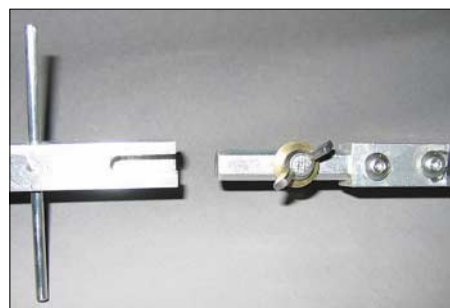
Bild 10: Einzelheiten des Boom-Stecksystems von DJ9YW, das ein Zerlegen der Yagi in vier Einzelstücke erlaubt.
