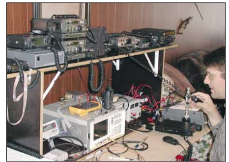
Bild 7: ON7BPs Messplatz für das senderseitige Phasenrauschen Fotos: ON7WP
