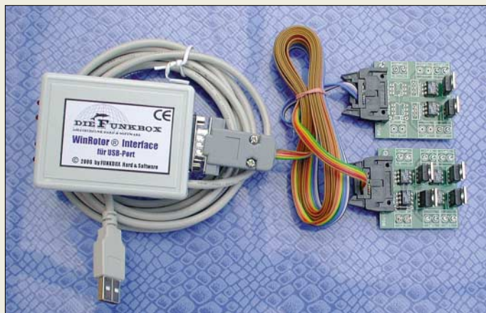
WinRotor USB-Satelliten-Interface mit zwei TRIAC-Platinen
