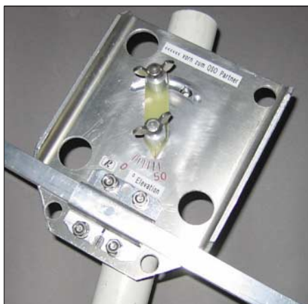
Bild 9: Eigenbau-Elevationsschelle für EME-Betrieb
