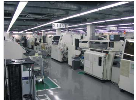
ICOM-Fertigungsline: Bestücken, Löten, Löttest
