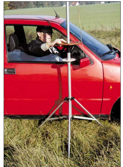
Bild 8: Die Bedienung der Drehvorrichtung durch das Fenster des Pkw. Ohne den Kopf zu heben, kann man auf der Skala die Hauptempfangsrichtung der Antenne ablesen.
