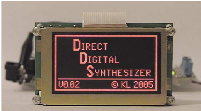
Bild 1: Die Platine für die Frequenzerzeugung und Transceiversteuerung wurde nur unwesentlich größer als das grafikfähige LC-Display gewählt, sodass sich beide als kompakte Einheit in einen Transceiver integrieren lassen.
