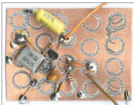
Bild 3: Die aus der Kupferbeschichtung herausgefrästen Flächen dienen als Lötstützpunkte für die aufzubauende Schaltung. Gute HF-Eigenschaften entstehen aufgrund der kurzen Verbindungen zur Massefläche.
