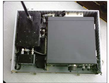
Ansicht von oben: links das Antennenanpassgerät, rechts der FT-747
