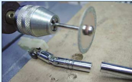
Bild 1: Mit der Trennscheibe einer Mini-Bohrmaschine ist die Teleskopantenne in wenigen Sekunden sehr sauber durchtrennt. Einen feinen Schnitt erreicht man ebenso mit einer Laubsäge.
