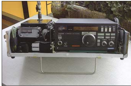
Links oben das Gelenk zur Senkrechtstellung der Stabantenne
