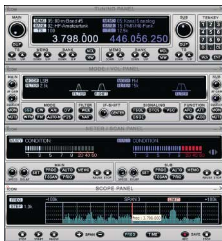
Die vier Module dieser Bedienoberfläche sind einzeln aktivierbar.
