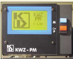
Das digital anzeigende, mikrocontrollergesteuerte Stehwellen- und Leistungsmessgerät KWZ-PM verfügt über einen abgesetzt installierbaren Messkopf und gestattet Datenübergabe an den PC. Der Beitrag macht mit den Möglichkeiten des aus deutscher Produktion stammenden Gerätes vertraut. Foto: Mittelstedt
