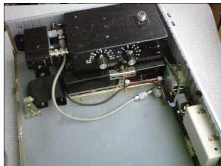
Rechts unten die Überwachungsschaltung, oben Mitte die beiden Akkus und darüber das Anpassgerät, links das SWR-Meter
