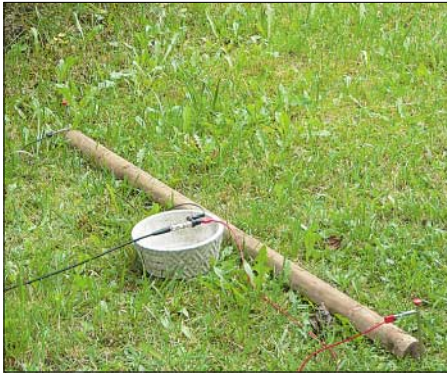
Bild 1: Zwei Einsteckelektroden und eine Zuleitung – mehr ist für eine Erdantenne nicht erforderlich.
