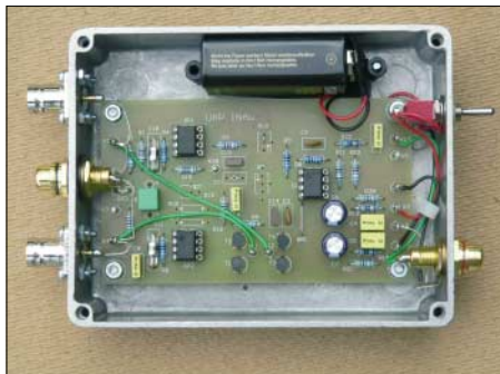
Bild 1: UAP INAw als Antennenanpassverstärker; die beiden äußeren BNC-Buchsen dienen zum Antennenanschluss, die Cinch-Buchse in der Mitte ermöglicht durch unterschiedlich bestückte Stecker eine Anpassung des Eingangskreises.
