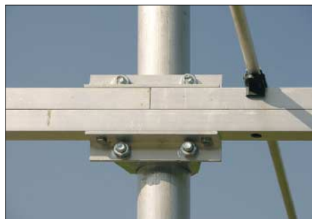
Bild 1: Der geteilte und mit einem Unterzug versehene Boom mit der Masthalterung
