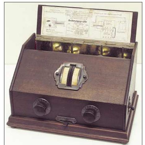
Der Telefunken T4, ein Zweikreisempfänger für Mittel- und Langwelle aus dem Jahr 1927
