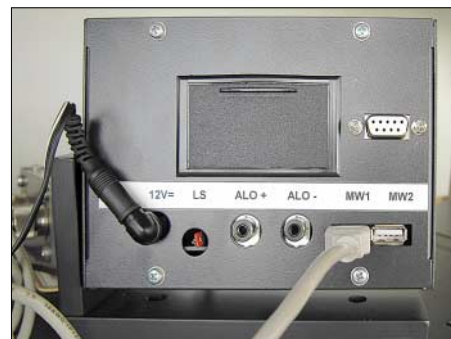
Bild 9: Alle Anschlüsse für die Anzeigeeinheit befinden sich auf der Rückseite: RS232-Schnittstelle, 12-V-Versorgungsspannung, Ladestecker für Akkumulatorbetrieb, ALO-Steuerkreis sowie zwei Anschlüsse für die Messwandler. Fotos: Autor
