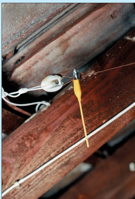
Bild 3: Geteiltes Krokodilkabel als Abstimm-element Fotos: OE5CWL (2), DF9GH (1)
