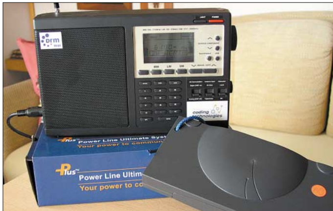
Bild 5: Gegen den Störpegel von Powerline Communication haben trotz Fehlerschutz auch moderne Übertragungsverfahren keine Chance: Bei PLC-Versuchen in Linz war es schnell vorbei mit DRM-Empfang auf Kurzwelle.
