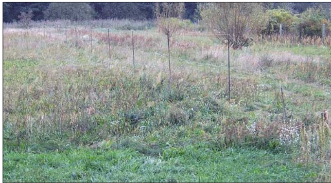
Bild 1: Beverage-Antenne bei DL7CM, am rechten Bildrand befindet sich die Einspeisung; die eigentliche Einspeisestelle ist jedoch unter dem Erdboden verborgen.
