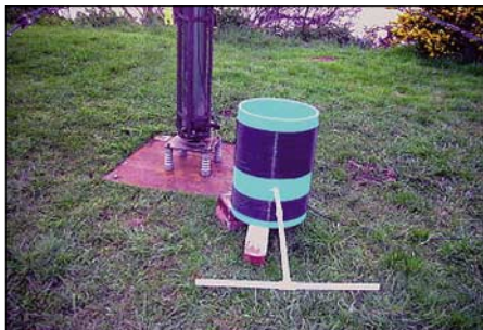
Die Langwellen-Ladespule nach dem bewährten Motto „je größer desto besser“
