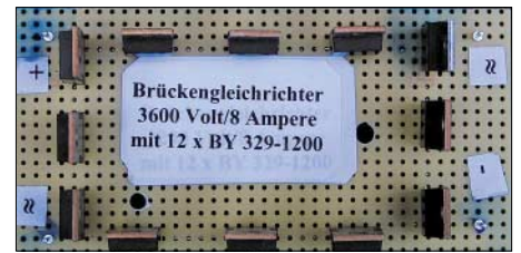
Bild 5: Brückengleichrichter mit zwölf Dioden des Typs BY329, die für Ströme bis 8 A und Sperrspannungen bis 3600 V geeignet sind
