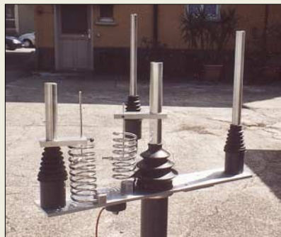
Fertig errichtete Antenne sowie unterer Rohrsteckaufbau mit Einspeisung und abgleichbereiten Fußpunktpulen
