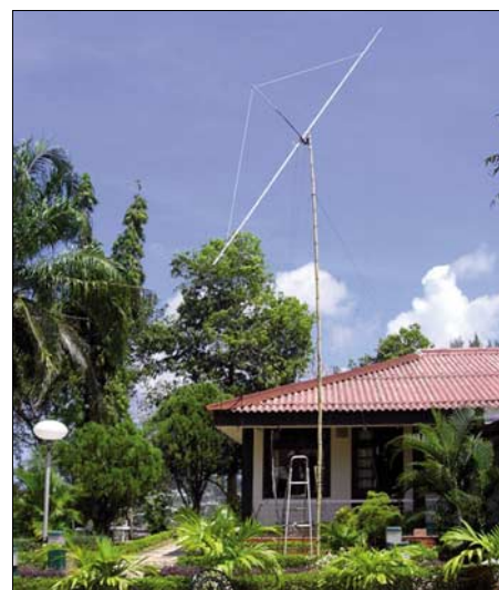
14-Element-Kreuzyagi von M 2 – bereit für den erstmaligen EME-Betrieb von VU4 Fotos: DL9MS
