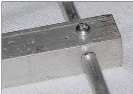
Bild 3: Elementmontage von 4-mm-Rundstäben durch einen 10 x 10-mm 2 -Boom
