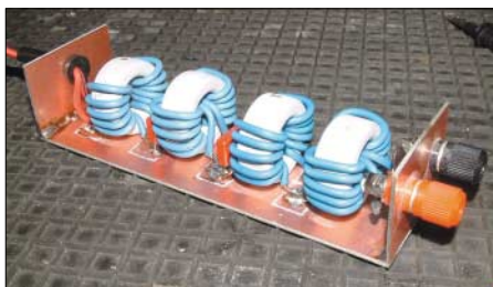
Bild 2: Erster Aufbau als externes Filter mit stehenden Ringkernen
