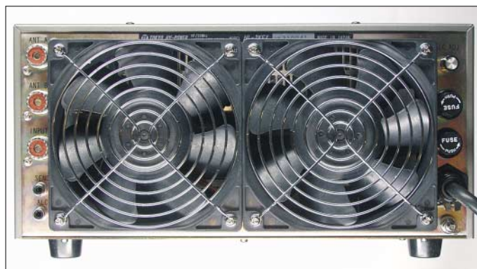
Bild 6: Rückansicht der Linear-Endstufe HL-2KFX. Den meisten Raum nehmen die beiden großzügig dimensionierten Ventilatoren ein. Links bzw. rechts sind die Anschlussbuchsen und Sicherungseinsätze erkennbar.
