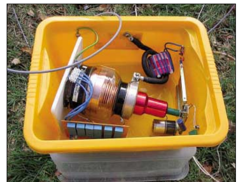
Was hier so aussieht wie ein Teil der Küchenausstattung des Urlaubs-QTHs von Dave ist in Wirklichkeit die Antennenanpassung der Loop.
