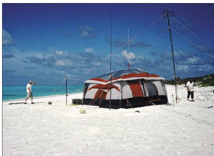
Ein 250 m langer, zugeteilter Strandabschnitt war unser Zuhause für etliche Tage. Im Vordergrund zu sehen sind ein Stationszelt mit Vertikalantennen sowie einer Gigahertzantenne (Richtfunkstrecke für DXA ins Festgebäude).
