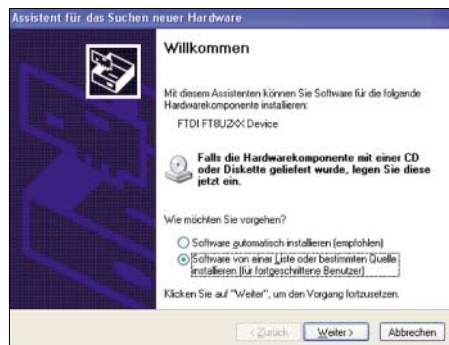
Bild 8: Im ersten Installationsschritt ist die Option, den Treiber selbst festzulegen, auszuwählen.
