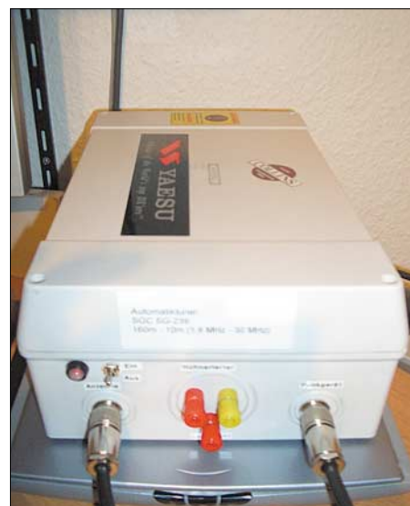
Bild 2: Ausgestattet mit den benötigten Anschlussbuchsen und einer integrierten 12-V-Stromversorgung lässt sich der geschützte SG-239 flexibel einsetzen. Fotos: DD9HK
