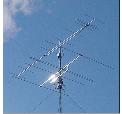
Bild 3: Die Antenne passt noch an das Drehrohr des Rotors und sitzt nun knapp 1,5 m unterhalb der 2-m-Yagi. Fotos: DL2RD
