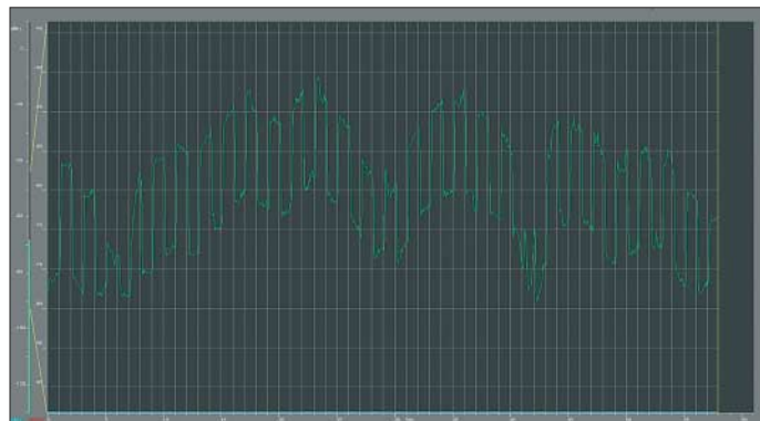
Bild 4: Trotz QSB mit unregelmäßigen Schwankungen ist es durch häufiges Umschalten möglich, den Antennengewinn zu evaluieren.
