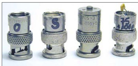
Bild 5: Die drei BNC-Kalibrierstandards und ein Teststecker
