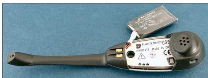
Blick ins Freetec-DECT-Headset: rechts die Mikrophonkapsel. Der goldbraune Draht (Pfeil) ist die Antenne.
