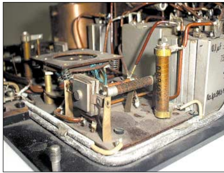
Bild 7: Die Röhrenfassung mit der ersten Stufe federnd; abgeschirmte Kabel
