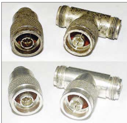
Zwei N-Steckverbinder mit sichtbarem Belag, oben vor und unten nach der chemischen Reinigung. Foto: DO1MWH
