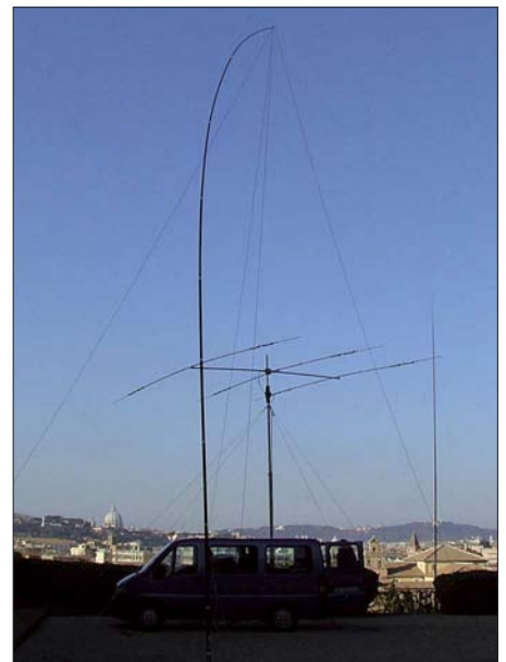
Die 40-m-Vertikalantenne sowie der A3S-Beam
