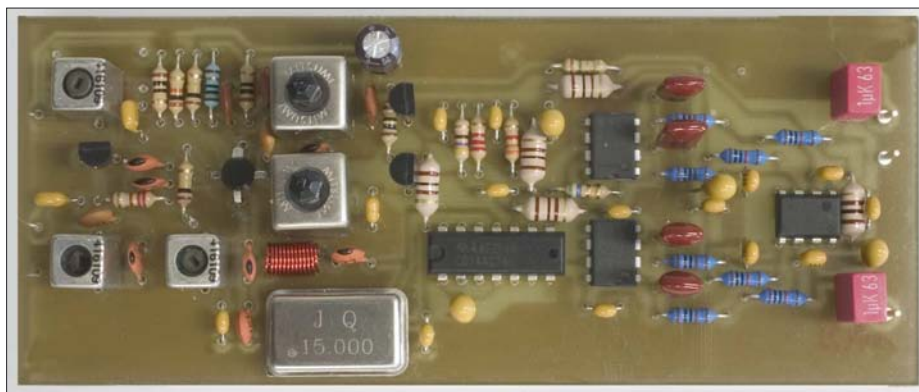
Bild 4: Testaufbau des 6-m-IQ-SDR-Systems, noch mit 15-MHz-Taktoszillator bestückt. Um die einwandfreie Funktion zu gewährleisten, ist der Einbau in ein Weißblechgehäuse sinnvoll.
