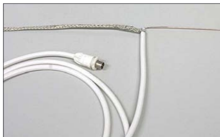
Bild 2: Behelfs-Dipol aus Koaxialkabel
