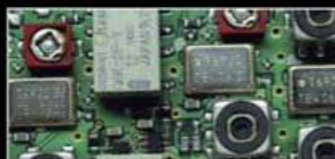
1. ZF: Drei Roofing-Filter bei 69,45 MHz
