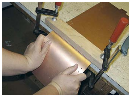
Bild 5: Das angeritzte Epoxid bricht nach einigen Wippbewegungen. Fotos: SM5ZBS
