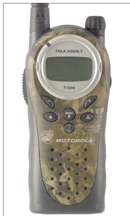
Bild 2: Motorola Talkabout T7200 [3] sieht aus wie ein PMR446-Funkgerät, ist aber für FRS programmiert. Fotos: Werkfotos
