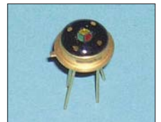
Bild 3: Bei den RGB-Farbsensoren der MCS3-Serie kann man die drei Farbbereichsfilter deutlich erkennen. Foto: Sander
