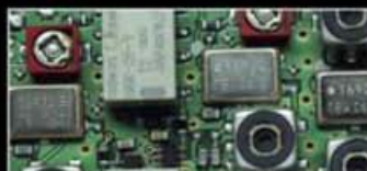
1. ZF: Drei Roofing-Filter bei 69,45 MHz
