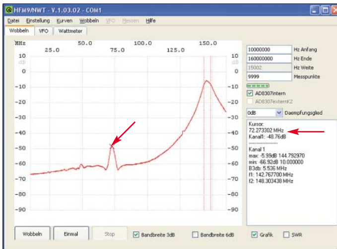
Bild 1: Die Steuerung der Wobbeldurchläufe ist über das entsprechende Arbeitsblatt möglich. Alle aufgenommenen Messwerte werden grafisch ausgegeben – einzelne Messwerte lassen sich per Cursor ermitteln.
