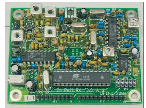
Bild 9: Auch die Kurzversion der Platine enthält alle Bauteile des Peilers, bis auf die Bedienelemente und das LC-Display.
