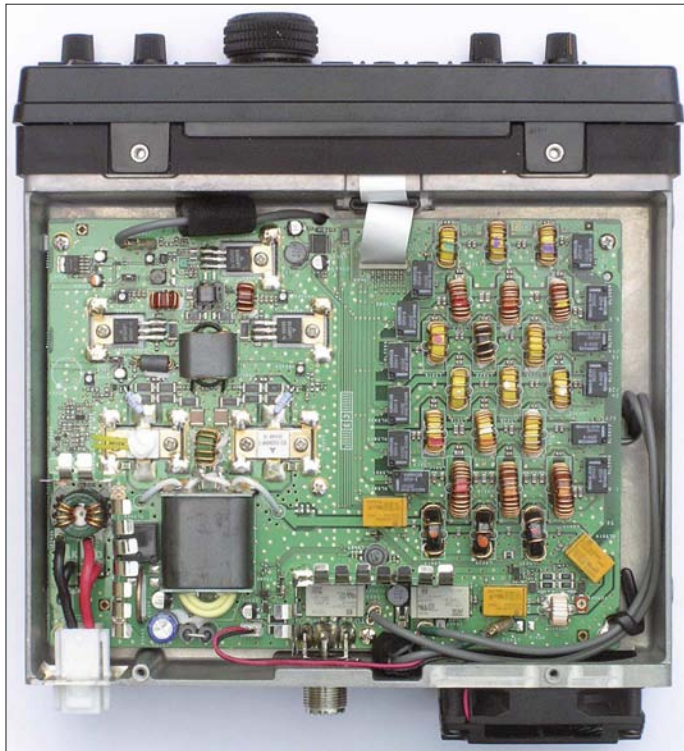
Bild 4: Innenansicht von oben; die wesentlichen Baugruppen sind hier die Senderendstufe und der Antennenfilterblock rechts.
