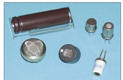
Bild 2: Die Gassensoren gibt es je nach Gas in verschiedenen Bauformen.
