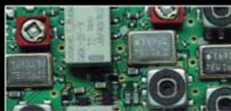
1. ZF: Drei Roofing-Filter bei 69,45 MHz
