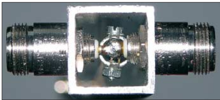
Bild 11: Anschluss eines Aluminium-Innenrohres an die Koaxialbuchsen
