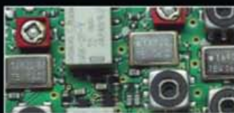
1. ZF: Drei Roofing-Filter bei 69,45 MHz
