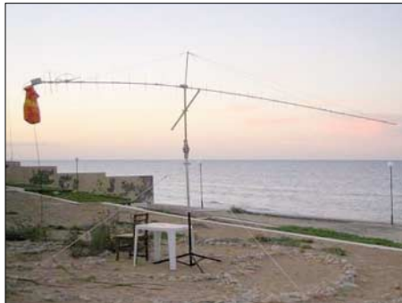
Direkt am Mittelmeer: die Spezial-Yagi von 5A7A. Man beachte den Sack am Ende des Booms für die Gewichte bei Elevationsbetrieb. Fotos: DL8YHR
