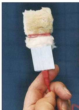
Bild 1: Zinkelektrode mit aufgestecktem Tampon; wichtig ist, dass der Tampon immer gut mit Elektrolyt vollgesaugt ist.
