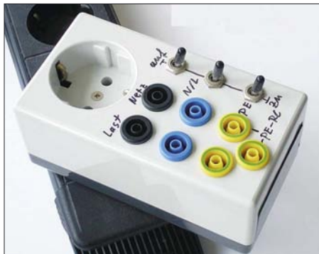
Bild 1: Ein einfach aufzubauender Messadapter lässt sich zwischen Steckdose und Gerät einschleifen, ohne bei Strommessungen Leitungen auftrennen zu müssen.
