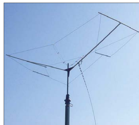
Bild 8: Diese Ansicht lässt Phasenleitung, Speiseleitung und Abstandshalter gut erkennen.
