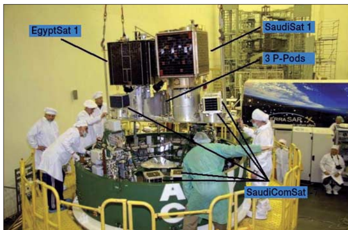
Die Integration der Satelliten in die Dnepr-Rakete.
