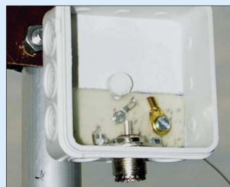
Bild 9: Anschlussdose, noch ohne den Balun nach W1JR Fotos: DK7ZB
