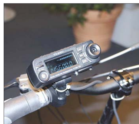
Bild 4: Das wasserdichte Bedienteil kann auf dem Lenker eines Fahr- oder Motorrads montiert werden. Fotos: Red. FA (2), Yaesu (1)
