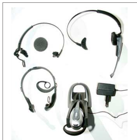
Bei Plantronics gibt es neben der Ladestation auch noch Ohrbügel in unterschiedlichen Größen und Arten, sowie verschiedene Polster. Fotos: Anycom (2), DL2MCD (4)
