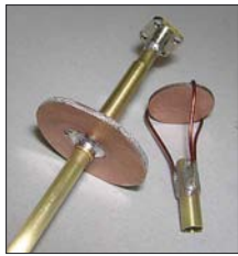
Bild 15: Führungsrohr mit Flansch und Pfennigstrahler
