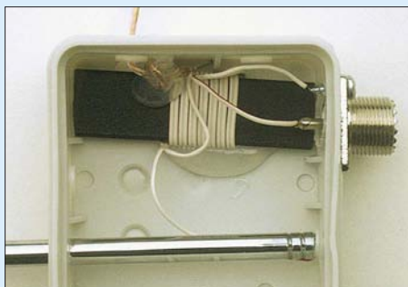
Bild 6: Anschlussdose mit Mantelwellensperre; die Radials kommen an den oben herausguckenden Draht, keinesfalls an die Schraube an der PL-Buchse!
