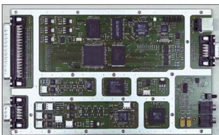
DSP-Modul TRX3C des ADT-200A. Foto: HB9CBU
