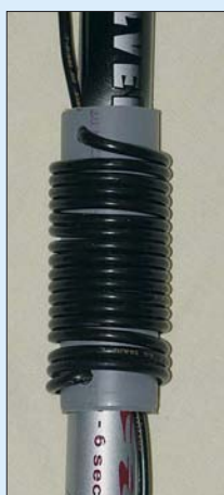
Bild 8: Diese Speisedrossel eignet sich besonders für die Angelruten-Variante.
