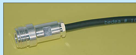
Bild 51: Nach dem Anziehen der Mutter sollte ein schmaler Spalt verbleiben.
