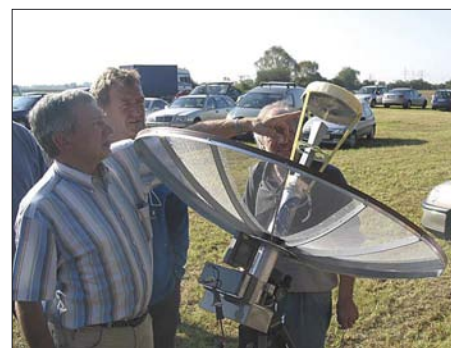
Freddy de Guchteniere, ON6UG, erklärt den Aufbau seines Eigenbau-Gitterparabolspiegels zum Empfang interplanetarer Raumsonden. Fotos: DF1GW, DL0TTM, DL8IJ
