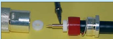
Bild 21: Vor dem Festlöten des Innenstifts die erste Isolations-scheibe aufschieben.
