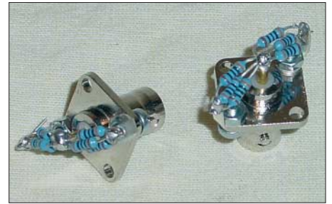
Bild 14: Abschlusswiderstände auf BNC-Basis Fotos und Screenshot: DK7ZB
