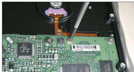
Bild 4: Ausbau der defekten Steuerplatine mit Torx-8-Schraubendreher.
