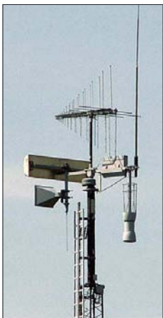
Bild 2: Peilerkopf im Detail: drehbare Logperiodic-Kreuzyagi für VHF/UHF, darunter Flächenantenne sowie Hornstrahler für SHF, rechts außen Vertikalstrahler
