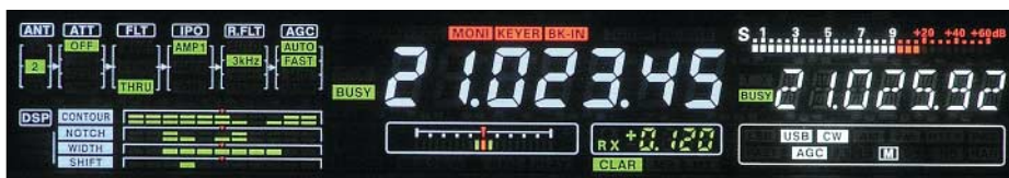
Bild 6: Das mehrfarbige VFD holt das Machbare aus diesem System heraus. Links oben das Blockschema des Empfängereingangsteils, darunter die DSP-Einstellungen. In der Mitte unten der vielseitige Abstimmindikator, daneben das Multi-Display-Fenster. Das rechte Drittel gehört im Wesentlichen dem Sub-Empfänger.
