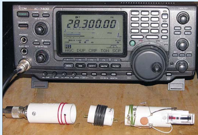
Bild 6: Praktisches Ausmessen eines Koaxialkabeltraps für 28,3 MHz
