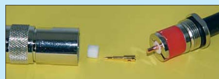
Bild 28: Die Innenisolation schneidet man bündig mit dem Kegel ab.
