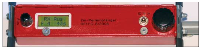
Bild 7: Die russische Bauform des Peilers, siehe Text, dient gleichzeitig als Griff und Antennen-Boom.
