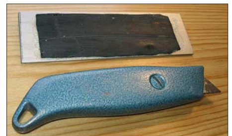
Bild 1: Hauptutensilien sind ein gerades Metallstück mit angeklebter Gummischicht und ein stabiles Teppichmesser.
