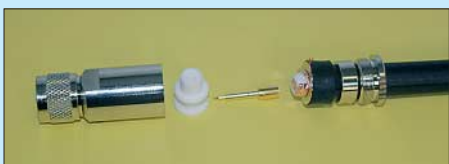
Bild 33: Nach dem Entwirren des Geflechts den Schaftkegel bis zum Mantel einschieben.
