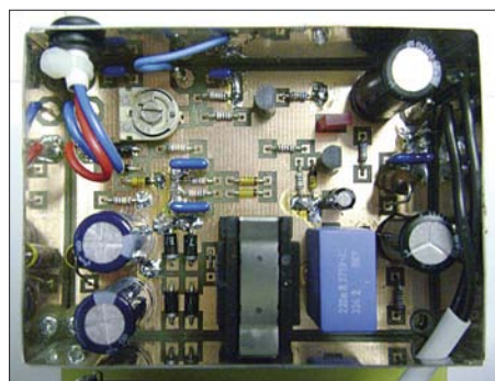
Bild 1: Elektronische Anodenbatterie im Weißblechgehäuse Foto: DB1NV
