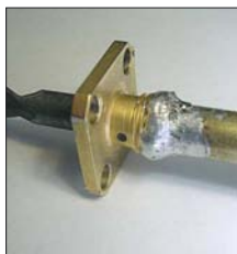
Bild 10: SMA-Buchse als Hohlleiterflansch
