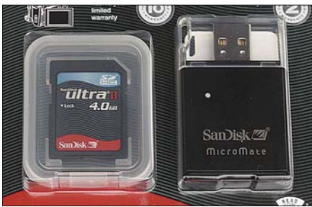
Bild 4: Gibt es ab 60 € im Set mit dem momentan unentbehrlichen SDHC-Kartenleser: Sandisk SDHC-Karte „Ultra“ mit einer maximalen Geschwindigkeit von 10 MB/s, entsprechend Class 4 oder 80fach
