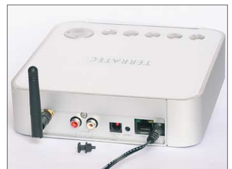
Bild 4: Ein Blick auf das Anschlussfeld von Terratecs Noxon 2 Audio. Über eine seitlich liegende USB-Buchse lassen sich externe Datenspeicher mit Audiodateien anschließen.
