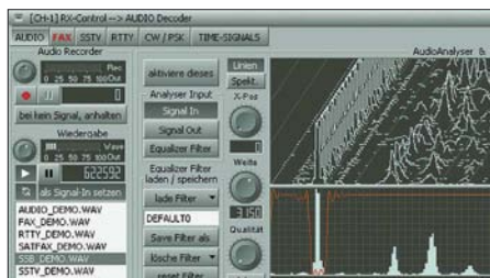
Bild 9: Einmal gemachte Filtereinstellungen können komfortabel als Equalizer-Dateien gespeichert und wieder abgerufen werden. Der Filterverlauf lässt sich im unteren Feld einfach mit der Maus vorgeben.
