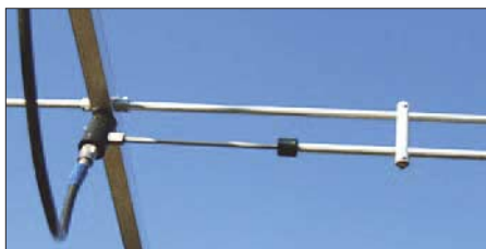
Bild 2: Gamma-Anpassung mit SO239-Buchse für hohe Leistungen
