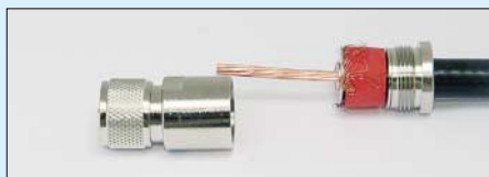
Bild 8: Nach dem Entfernen der Isolierung des Innenleiters geht es an die Endmontage.
