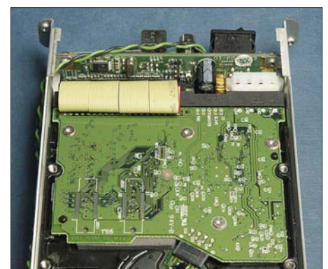
Bild 1: Ein Blick in eine industriell gefertigte externe USB-Festplatte fördert neben einer normalen IDE-Festplatte auch nur eine kleine Platine zutage, die zwischen den USB- und IDE-Schnittstellenpegeln und -protokollen umsetzt.
