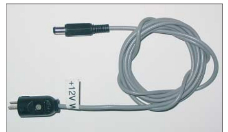
Bild 4: Beschriftung mittels Labelprinter für gerätespezifische Kabel
