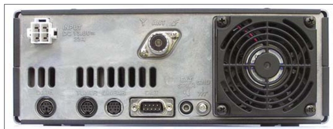
Bild 2: Die Rückfront des FT-450; links die Buchsen für DATA, externen Antennentuner, Linear, Computersteuerung und externen Lautsprecher. Der große Lüfter läuft bei Empfang sehr leise.
