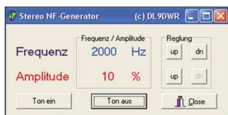
Bild 1: Bedienoberfläche des NF-Generatorprogramms nf_sound.exe
