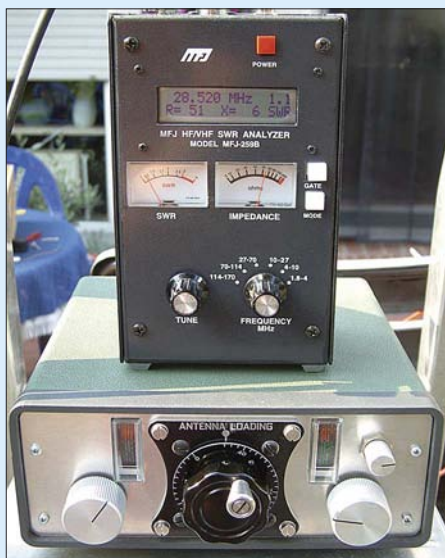
Bild 16: MFJ-Antennenanalysator mit Selbstbaukoppler Fotos: DC1DV
