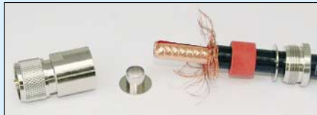
Bild 5: Nach dem Entfernen des Mantels muss man die Schirmung entflechten.
