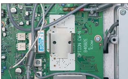
Bild 4: Ein schmales CW-Filter ist nachrüstbar.
