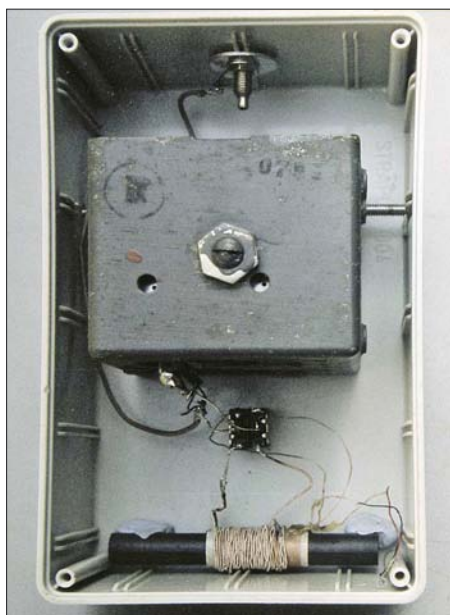
Bild 3: Innenansicht des Fuchskreises; damit der Ferritstab möglichst nahe am Empfänger liegt, ist er unten einzubauen.
