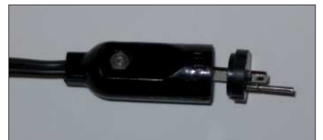
Bild 3: Innenleben eines minderwertigen Lautsprechersteckers – der Lötvorgang hat den Stift gelockert.
