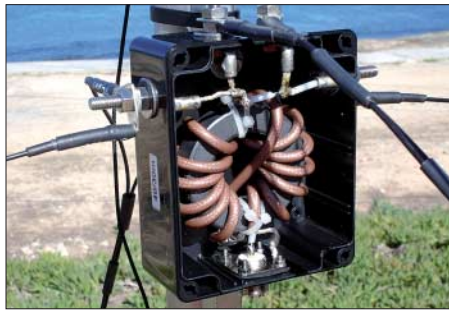
Die Einspeisebox des großen Spiderbeams
