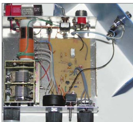
Bild 4: Innenleben des ADDX-Verstärkers, auch als Bausatz erhältlich
