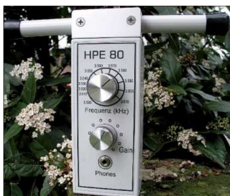
Der 80-m-Peilempfänger HPE 80 von DL3BBX
