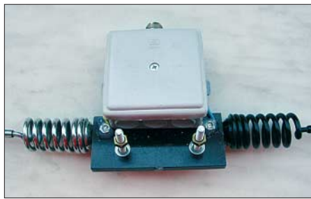
Bild 2: Von den Strahlern führen zwei Drähte in den Kasten. Fotos: DL8ZX (2)
