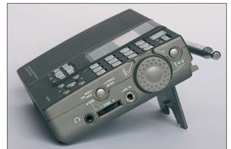
Bild 3: Über ein VFO-Rad auf der rechten Gehäuseseite lassen sich Frequenzen bequem manuell einstellen. Dort liegt auch die SSB-Feinabstimmung.
