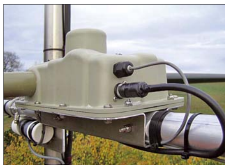
Bild 2: Ansicht des Elementegehäuses mit Elementestützen hinten und Steuerkabel vorn. Der Schrittmotor befindet sich unter der Ausbuchtung in der Gehäusedecke. Die PL-Buchse verrät den spezielleren Verwendungszweck dieses Gehäuses.
