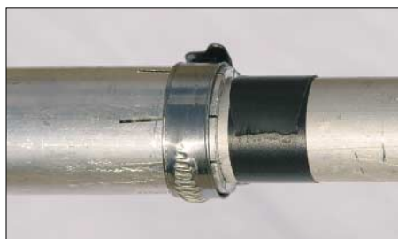
Bild 5: Die verschiebbaren Rohrübergangsstücke mit der Schlauchschelle
