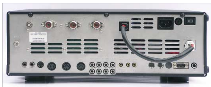
Bild 2: Die Rückfront offenbart neben diversen Anschlussmöglichkeiten vier Antennenbuchsen, zwei für den Sender und je eine für separaten Empfänger und das Einschleifen eines externen Empfangsfilters.
