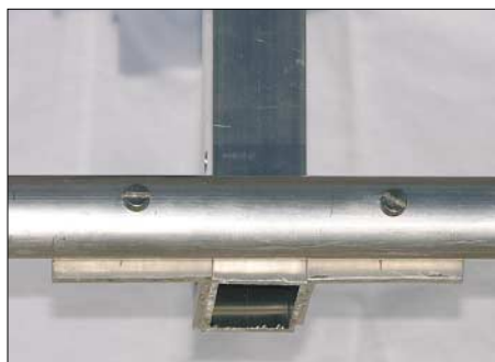
Bild 8: Befestigung des Parasitärelementes
