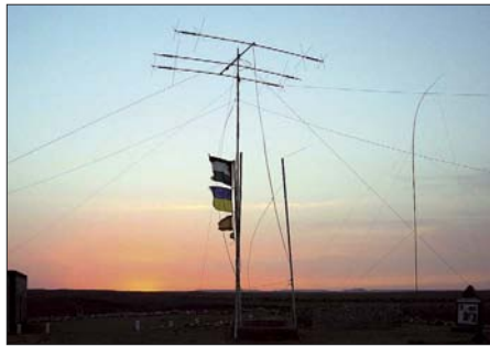
Der Cushcraft-Minibeam MA5-B zum Sonnenuntergang; rechts daneben die 22 m hohe Inverted-L für das 160-m-Band
