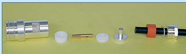
Bild 46: Zur Buchse gehören zwei Isolationsscheiben.
