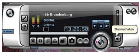
Bild 4: Bedienungsoberfläche „Modern Black Panel“, linke Skala Feldstärke, rechte vermutlich Bitfehlerrate (grün = optimal)
