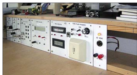
Bild 1: Einbau des Modulsystems in einem Tischregal eines Schreibtisches; deutlich erkennbar sind die beiden Vierkant-Holzleisten oben und unten, an denen jedes Modul mit je zwei Holzschrauben fixiert ist.
