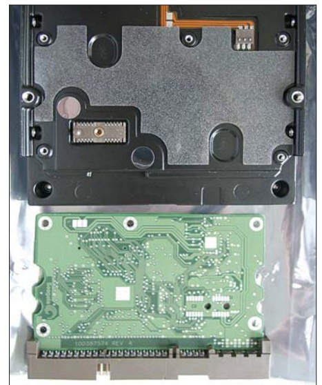
Bild 5: Plattengehäuse mit Anschlüssen für Motor (oben) und Schreib-/Leseelektronik (unten rechts). Fotos: DL8KFO
