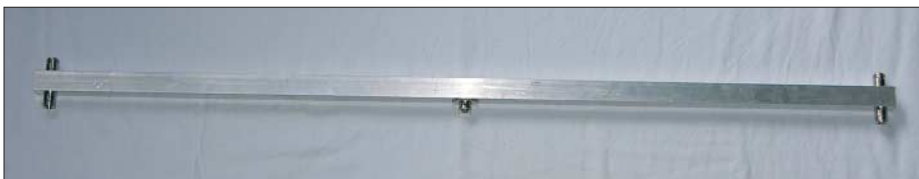
Bild 12: 2-m-Anpasstopf für vier Antennen nach dem Halbwellenprinzip
