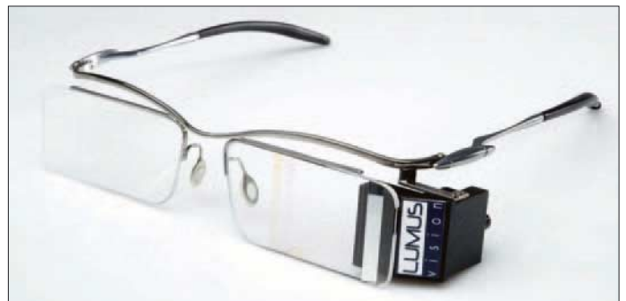
Bild 2: PD-21 (320 x 240 Pixel, QVGA, 22° Bildwinkel) oder PD-25 (640 x 480 Pixel, VGA, 27,5° Bildwinkel) – die einkoppelnden Segmente im Glas sind nur ganz aus der Nähe zu erkennen.
