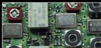
1. ZF: Drei Roofing-Filter bei 69,45 MHz
