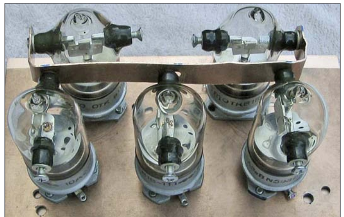
Bild 3: Die Anordnung von fünf Vakuumrelais als Bandwahlschalter; die Sammelschiene wird mit dem Ausgang des \Pi -Filters verbunden (C Ant), an den freien Kontakten der Relais werden die einzelnen Spulenabschnitte angeschlossen.
