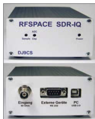
Bild 9: Ansicht des Standardgehäuses der Abmessungen 104 x 48 x 104 mm 3 mit der SDR-IQ-Platine. Das Seriengerät wird ein anderes Gehäuse besitzen.
