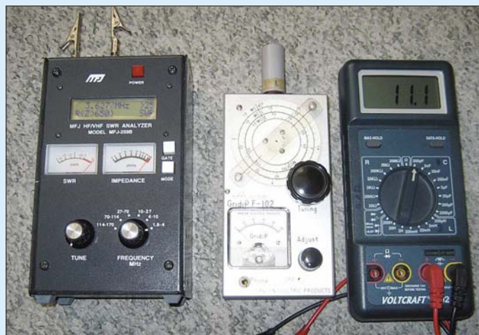
Bild 8: Mess-Trio Antennenanalysator MFJ-259B, Dip-Meter und Vielfachmesser; zum leichteren Ankleben der Drähte an den MFJ-259B wurden Krokodilklippen auf einen Bananenstecker für die PL-Buchse und einen Messingwinkel für die Gehäuseklammer gelötet. Das vermeidet die beliebten Lüsterklippen und man ist damit schneller. Fotos: DC1DV
