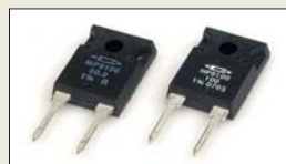
100-W-Widerstände mit 50 bzw. 100 \Omega im TO-247-Gehäuse
