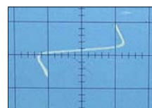
Bild 4: Kennlinie der Diode mit negativem differenziellem Widerstand
