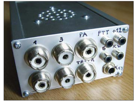
Bild 5: Für die Umschaltbox eignet sich das Aluminiumgehäuse 1030 von Conrad sehr gut. Es muss flach sein, da an der Rückseite diverse, mitunter störrische Koaxialkabel anliegen. Fotos: DL7CM
