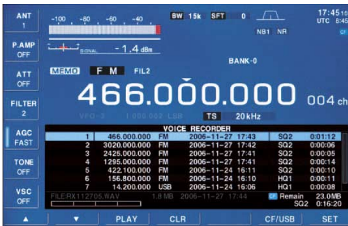
Bild 2: Das Display stellt 800 x 480 Pixel dar und liefert detaillierte Informationen – hier die Aufzeichnungen des Recorders (links). Bild 3: Der Lüfter rechts im Bild greift nur bei hohen Temperaturen ein.
