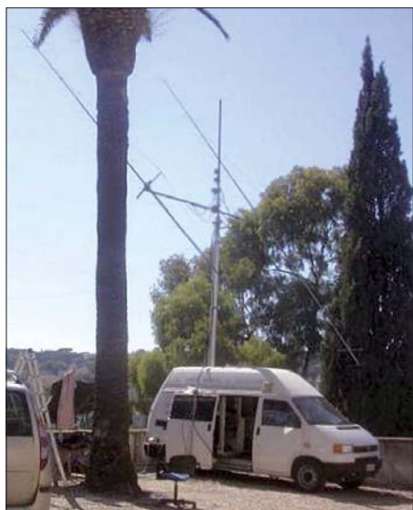
UKW-DX aus dem Bus – das EME-Set-Up von 1A0KM mit zwei 17-Element-M 2 -Yagis (18 dBd); man erkennt gut die störende Palme.
