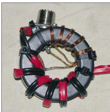
Bild 2: Praktische Ausführung des Baluns
