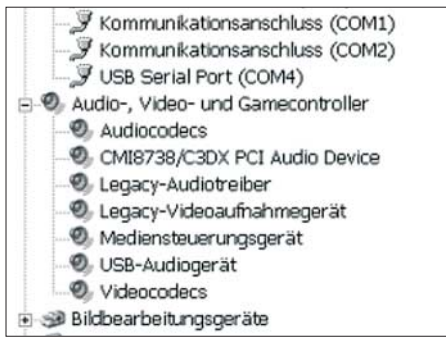
Bild 18: Hat alles geklappt, erscheinen die Geräte USB Serial Port und USB Audiogerät unter Windows im Gerätemanager.
