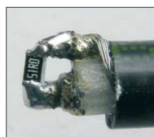
Bild 16: Anschluss der Referenz-Messobjekte an ein kurzes RG58-Kabel
