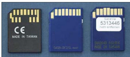
Bild 2: Neben geringfügig unterschiedlicher Dicke fallen bei Multimediacards (links) gegenüber SD (Mitte, rechts) lediglich mehr Anschlüsse und der fehlende Schreibschuttschieber auf.
