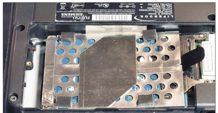
Bild 2: SATA-Festplatte im Fujitsu-Siemens Notebook
