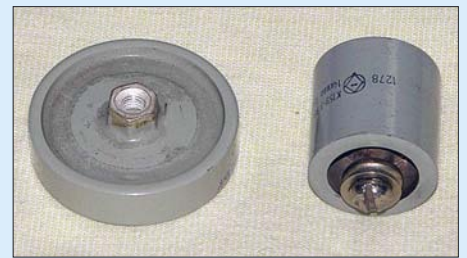
Bild 3: Spannungsfeste Kondensatoren aus russischer Militärtechnik
