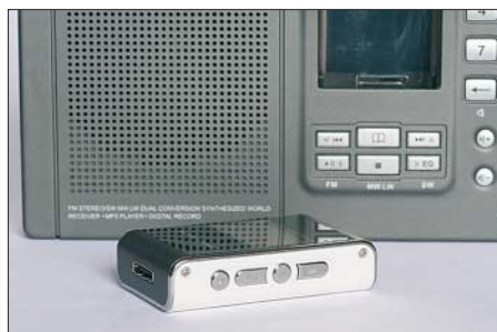
Bild 5: Der MP3-Recorder ist abnehmbar und lässt sich auch getrennt verwenden. Der Empfänger bleibt weiter nutzbar.
