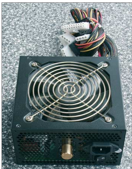
Höherwertige PC-Netzteile, wie dieses von SSM, besitzen einen leicht mit einem Lautstärkereger zu verwechselnden Knopf für die Lüfterleistung. Fotos: DL2MCD
