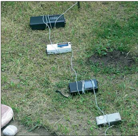
Bild 4: Während eines Versuches wurden mehrere Empfänger gleichzeitig über Kopplerwicklungen in eine große Schleifenantenne eingebunden. Die Empfangssignalerhöhung war beträchtlich.
