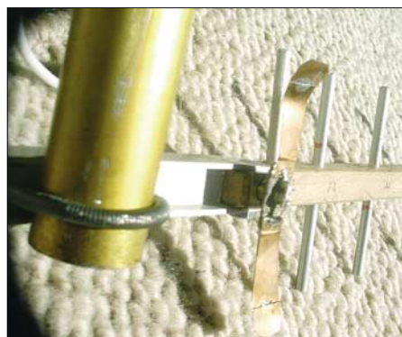
Bild 2: Detailansicht von Antennenhalterung (Doppel-T-Profil), Mastschelle, Boom (Vierkantholz) und Dipol (Kupferblech) mit Symmetrierung
