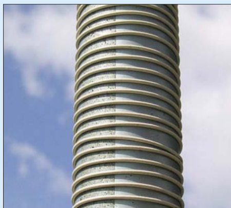
Bild 1: Teilansicht der mit isoliertem Draht, Außendurchmesser 1,25 mm, bei 4 bis 5 mm Steigung bewickelten Angelrute.
