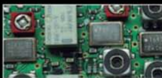
1. ZF: Drei Roofing-Filter bei 69,45 MHz
