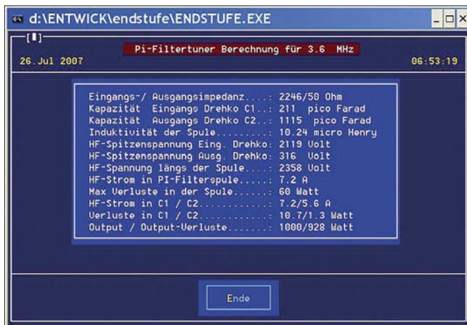
Bild 2: Berechnungsergebnis eines typischen \Pi -Filters in einer PA mit etwa 1000 W Output bei 3,6 MHz [3]; man beachte insbesondere die hohe HF-Spannung, die längs der Spule liegt, die HF-Ströme und die unvermeidlichen Verluste, die sich durch Erwärmung äußern und die Schaltkontakte, besonders bei Dauerbetrieb, erheblich belasten.
