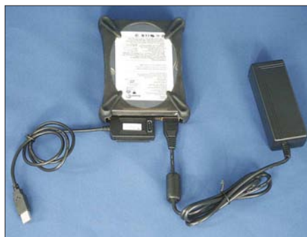
Bild 3: Anschluss einer Standard-3,5"-IDE-Festplatte mit übergezogenem Silikonmischschutz an USB-Adapter und Netzteil: Fertig ist die preiswerte Speichererweiterung!
