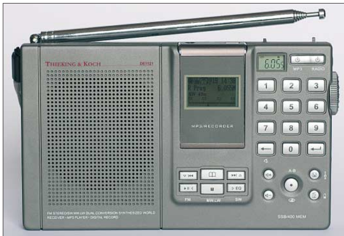
Bild 1: Der Thieking & Koch DE1121 ist das erste Reiseradio mit integriertem Digitalrecorder und Speicherverwaltung per Computer.
