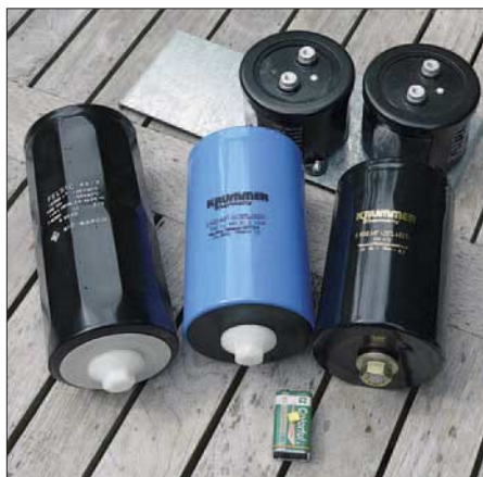
Bild 1: Hochvolt-Aluminiumkondensatoren mit hoher Kapazität besitzen ein beachtliche Größe. Als Vergleich erkennt man im unteren Teil eine 9-V-Blockbatterie, auf der ein Standard-MKT-Kondensator liegt.
