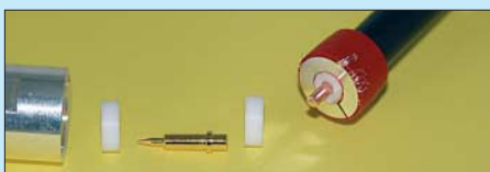
Bild 20: H2000 mit gekürztem Innenleiter und eingeschobenem Schafthkegel
