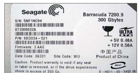
Bild 3: Typenbezeichnung der Harddisk; für einen erfolgreichen Tausch müssen Typenbezeichnung, Produktnummer und Firmware-Version identisch sein.
