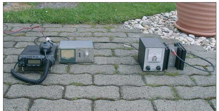
Bild 9: Verwendete Messtechnik, links FT-857 als Generator und Daiwa-Wattmeter CN-620, rechts OAK-Wattmeter WM1 und Abschlusswiderstand 100 W/2 GHz Fotos: HB9BXE
