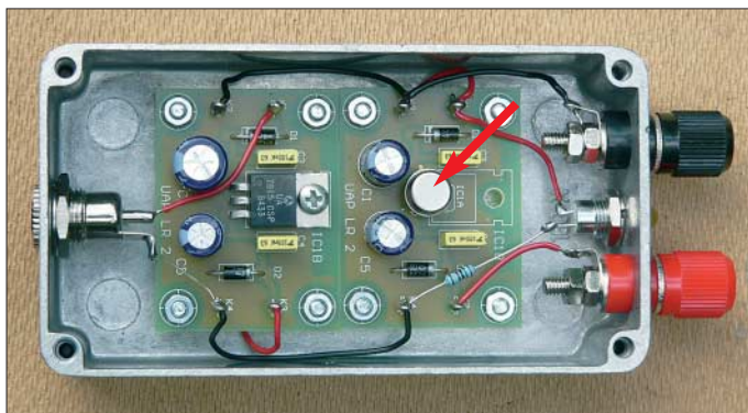
Bild 1: 10-V-Referenzgerät mit einem LH0070-2H als Spannungsreferenz. Die Platine UAP LR2 links dient zur Vorstabilisierung.
