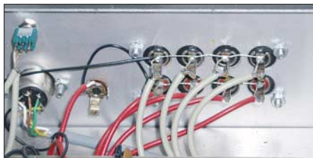
Bild 2: Verdrahtung der Cinchbuchsen in der Steuereinheit
