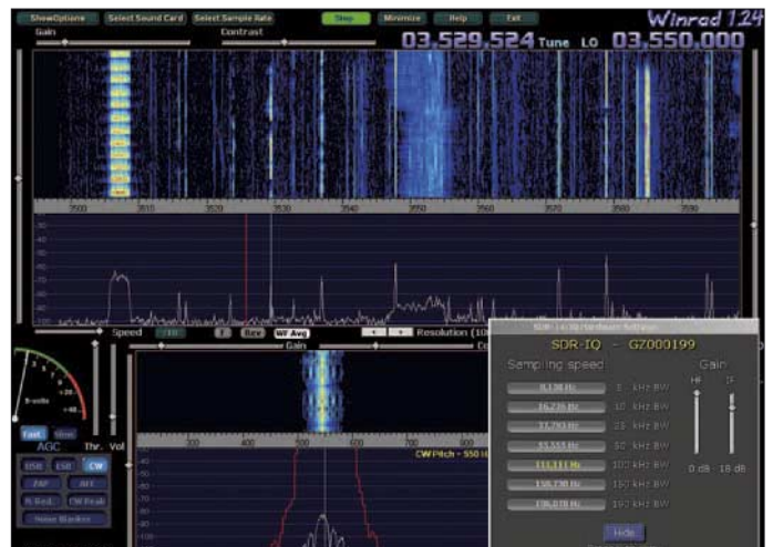
Bild 8: Einsatz der Software Winrad zusammen mit dem SDR-IQ als Empfängereingangsteil. Die Konfiguration des SDR-IQ erfolgt über das Menü rechts unten. Fotos, Screenshots: DJ9CS
