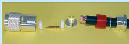
Bild 19: Diesmal reicht es, den Mantel auf 6 mm zu entfernen.
