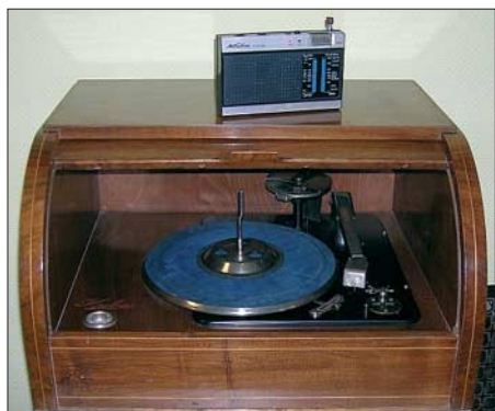
Das Transistorradio „Florida“ und die „Brottrommel“ - der Plattenspieler war das erste Kuba-Produkt überhaupt und hatte eine Nadelaufgabe von 0,5 N.
