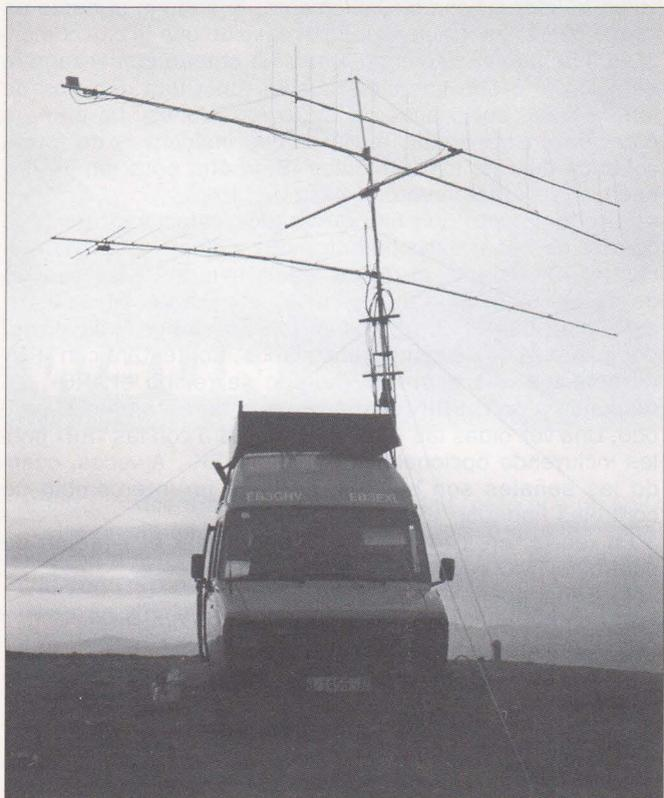
En ciertas condiciones, es útil disponer de antenas de polarización vertical, además de las usuales en horizontal.
