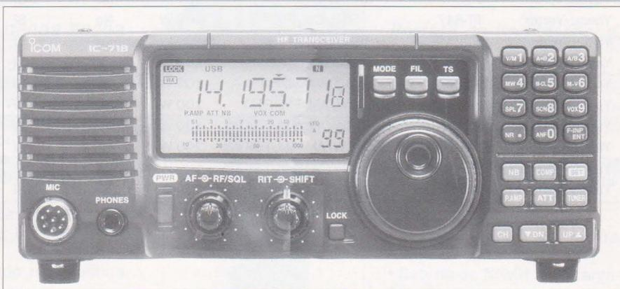
adicional. Requiere alimentación a 13,8 V y 20 A máximo y se sirve con un micrófono de mano HM-36
