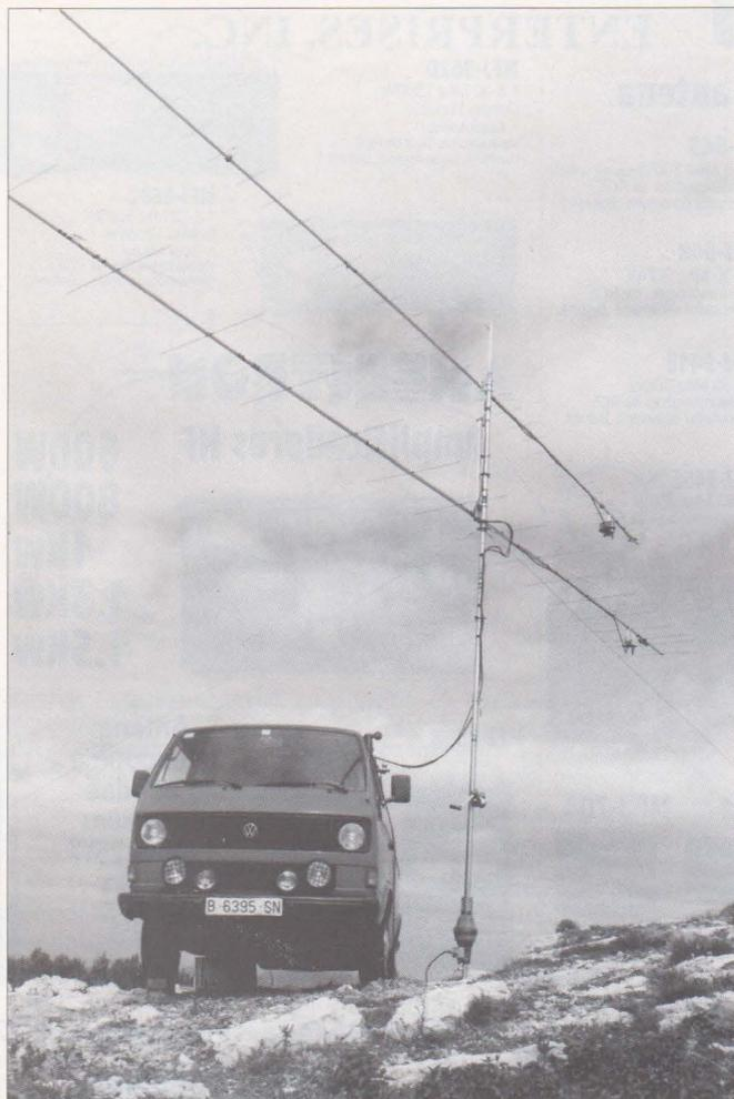
El trabajo serio de DX en portable exige una instalación de cierta envergadura, como este espectacular sistema de antenas para 144 y 432 MHz y dotado de un rotor.
