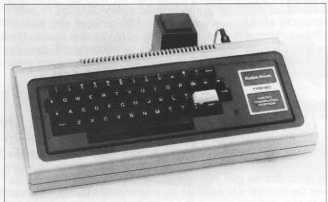
Foto C. El microordenador TRS-80 de Radio Shack gozó de una enorme popularidad en la década de los 80 y contribuyó a popularizar el arte de la programación en BASIC. Usaba un televisor estándar como monitor.
