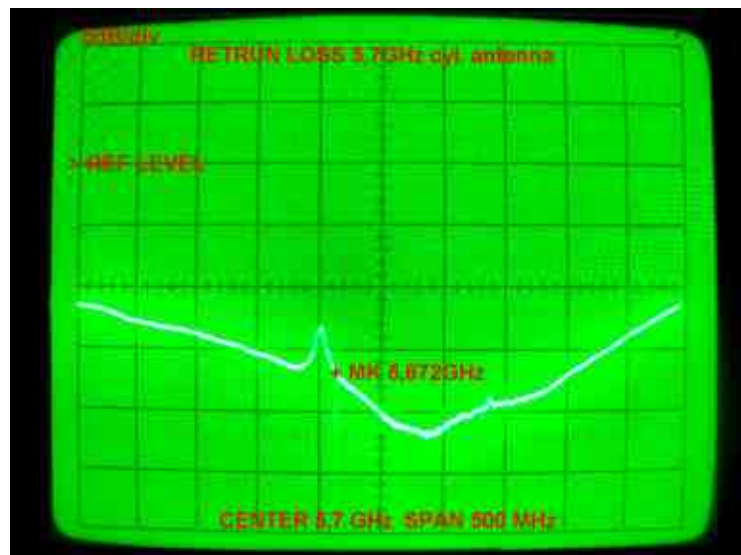
Figure 9 : Exemple de prise de vue sur le HP 182T +8755C (mesure d'une antenne 5,7 GHz).
