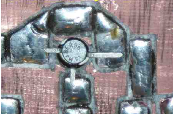
BFR96 dans son logement Photo 5
