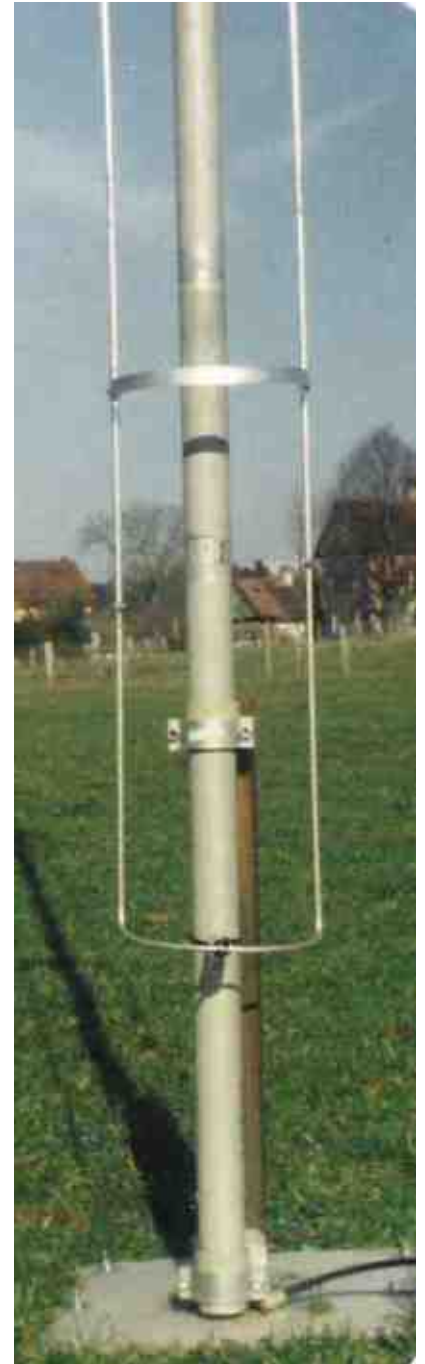
Boucle inférieure style trombone à coulisse- Tube Ø 7,5 mm
