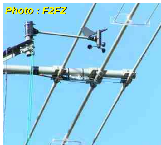
NB : le capteur météo est bien là, mais on distingue très bien les boucles sur le radiateur 20m.
