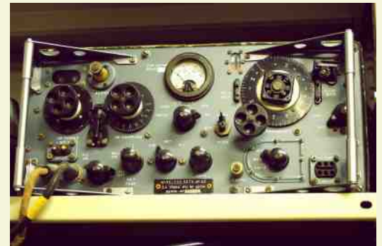
WS-62: émetteur-récepteur anglais, conçu et fabriqué par la maison PYE, en 1943/4. Couvre de 1.6 à 10MHz en AM et CW, avec une puissance d'environ 1W.
