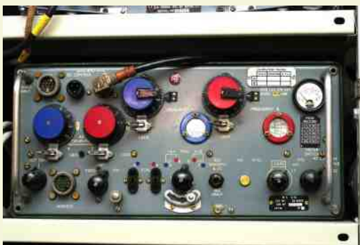
WS C12: émetteur-récepteur développé par la maison PYE, entre 1948 et 1950. Couvre de 1.6 à 10Mhz. La puissance de sortie est de 5W en AM et de 8W en CW. L'émetteur est modulé sur la plaque et l'écran, ce qui lui confère une modulation d'excellente qualité.
