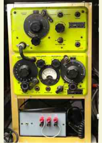
WS-21: émetteur-récepteur anglais couvrant de 4.2 à 7.5 Mhz et de 19 à 31 Mhz.
