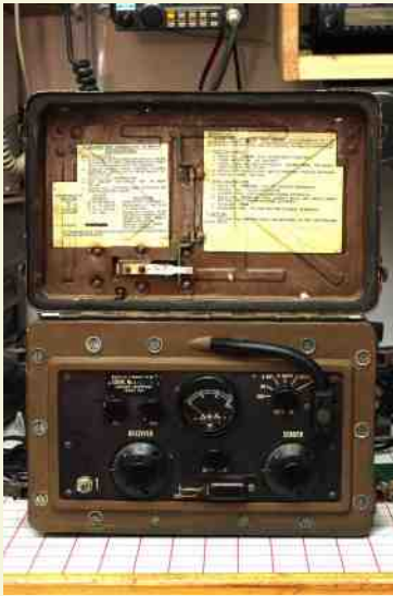
WS-62: émetteur-récepteur anglais, conçu et fabriqué par la maison PYE, en 1943/4. Couvre de 1.6 à 10MHz en AM et CW, avec une puissance d'environ 1W.
