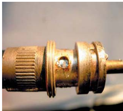
photo 10 : la tresse extérieure est visible
