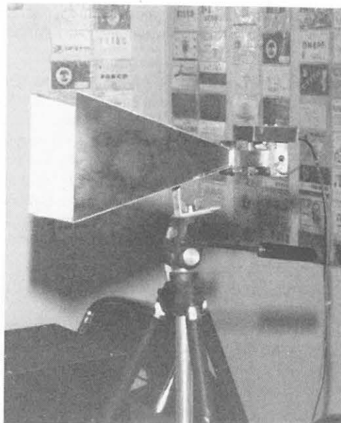
F6FYP, Florence et F1ELQ, Christian, de passage à Radio Mayenne - Ci dessous, un cornet 10 GHz, de fabrication amateur.
