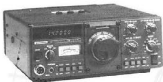
Émetteur/récepteur TS 130 SE Kenwood Tout transistor USB/LSB/CW/FSK - 100 W HF CW - 200 W PEP - 3,5 - 7 - 10 - 14 - 18 - 21 - 24,5 - 28 MHz
