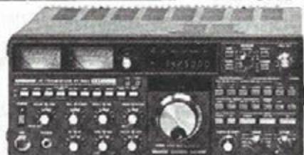
FT-980 Émetteur-récepteur toutes bandes. 240 watts PEP.
