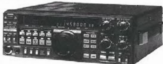
TRANSCIVER TOUS MODES USB/LSB/CW/FM Puissance variable en tous modes de 3 W à 25 W. Sensibilité : 0,1 W = 10 dB S+B/B BLU-CW 1 W = 38 dB S+B/B FM Alimentations secteur et continu incorporées. Pas de 10 Hz - 2 VFO - TCXO - 40 mémoires - scanning IF shift NB - Tone 1 750 Hz. Synthétiseur de voix en option.
