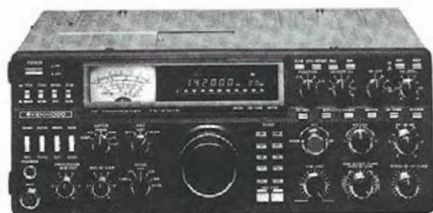
Emetteur-récepteur HF TS 930SP Emission bandes amateurs. Réception couverture générale tout transistor. AM/FSK/USB/LSB/CW. Alimentation secteur incorporée.
