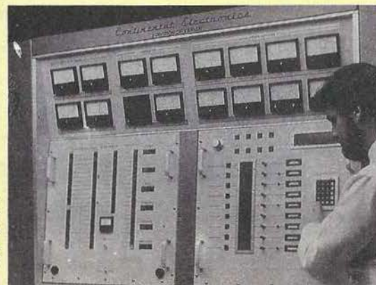
Emetteur ondes courtes 500 kW AM de Continental Electronics. La chaîne d'amplification comporte un étage transistorisé à large bande nécessitant 1 V efficace en entrée, un étage driver constitué d'une triode 3CW20, et un ampli de puissance utilisant une tétrode 4CM400000.
