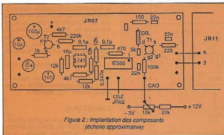
Figure 2 : Implantation des composants (échelle approximative)
