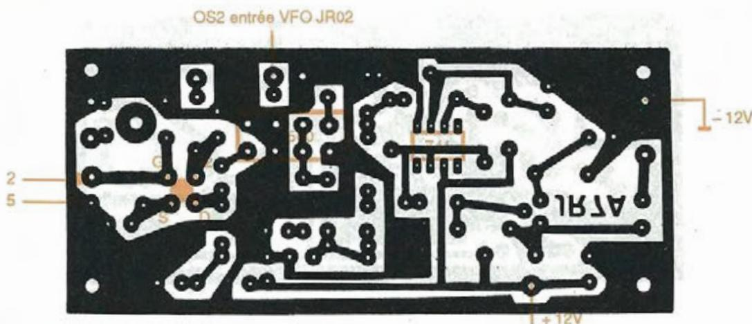
Planche 8 : Circuit imprimé JR07A vu côté cuivre, échelle 1/1
