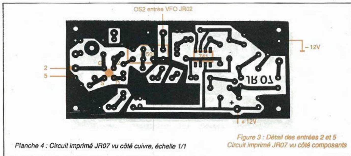
Planche 4 : Circuit imprimé JR07 vu côté cuivre, échelle 1/1
