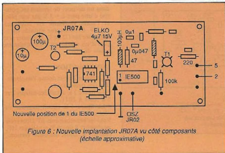
Figure 6 : Nouvelle implantation JR07A vu côté composants (échelle approximative)
