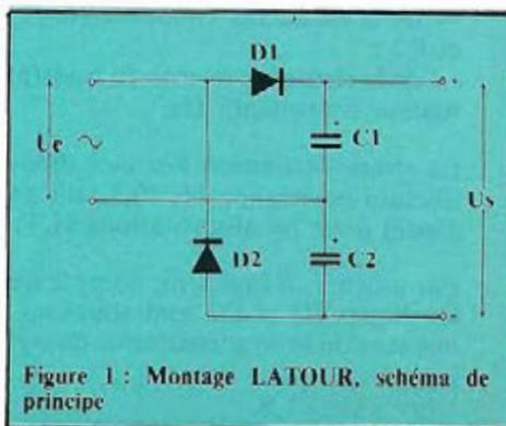
Figure 1: Montage LATOUR, schéma de principe
