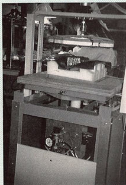
Banc testant la résistance aux vibrations.
