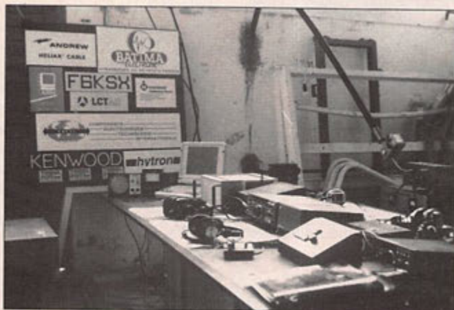
La station EME à l'intérieur du local de la SFM. De g. à d. : Cde antennes, ordinateur, transverter, TS440S et PS430 Kenwood, manip. électronique, filtre BF. Au fond : câble Andrew LDF 7/50, wattmètre et ampli.
