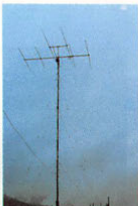
Antennes OK3LA, 5 éléments 10 m, HB9CV 15 m.
