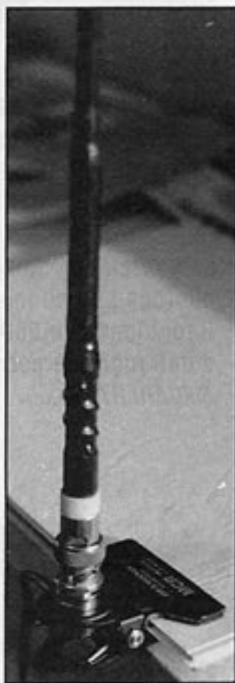
boudin en caoutchouc de votre pocket. Elle peut même servir provisoirement en fixation de gouttière ou sur des barres de toit ! Rien ne vous interdit, non plus, de mettre votre portable à la ceinture et l'antenne sur votre casquette ou encore, fixée au combiné casque-micro que vous avez coiffé. Le câble, du KX3, a une longueur de 2,5 m. Si vous manquez d'imagination, faites travailler vos méninges et vous verrez que les applications sont nombreuses. A découvrir chez G.E.S.
