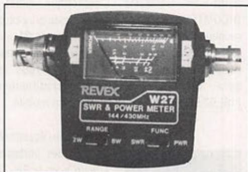
Les uns, équipés de BNC, pourront s'intercaler directement à la sortie antenne d'un petit portable, leur échelle de lecture étant, par ailleurs, verticale.
