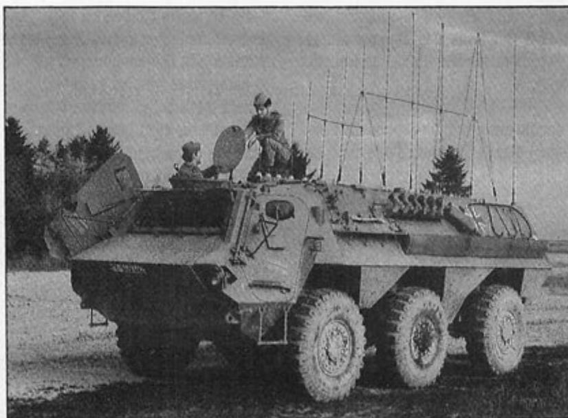
*Brouilleur VHF installé sur un véhicule blindé.*
