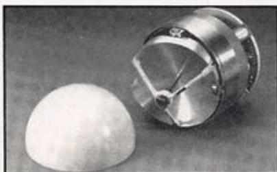
*Radar auto-directeur assurant la phase terminale du guidage d'un missile.*
