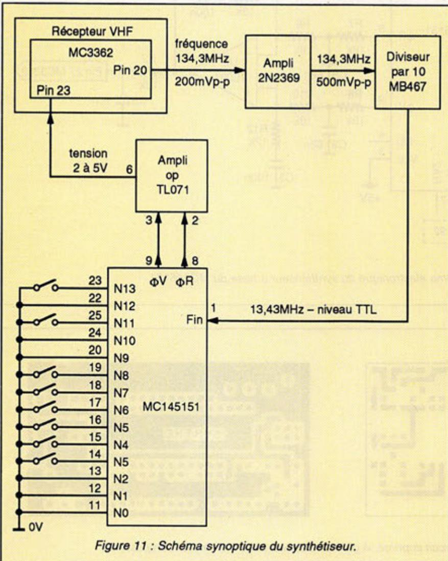
Avant, il faut bien sûr débrancher l'ancienne commande du VCO en retirant au moins le curseur du potentiomètre de la broche 27 du MC3362, ou en mettant un inverseur, pour pouvoir sélectionner le VFO ou le synthétiseur qui, alors, sert de mémoire.
