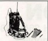
AN/PRC 9A - Emetteurs/récepteurs portables en FM, AN/PRC 9A couvre de 27 à 38,9 MHz - Couverture en accord continu par maitre oscillateur - Puissance HF : 1 W - Très bel état, vendu avec garantie - Livré avec documentation, schémas.
