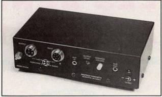
d'entrée et de sortie étant faites par l'intermédiaire de connecteurs et de câbles en nappe. Un haut-parleur de contrôle est présent dans le boîtier. L'amplificateur audio est un classique LM 386. La sortie vers le circuit de modulation de l'émetteur (ou tout autre accessoire que vous voudrez bien brancher sur le DR-3) est effectuée à travers un transformateur. Des ferrites, placées sur les liaisons BF limitent les risques de retours HF.
