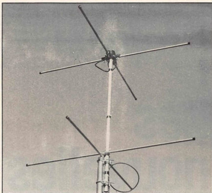
La MSA-20 est réalisée entièrement en tubes d'aluminium.
