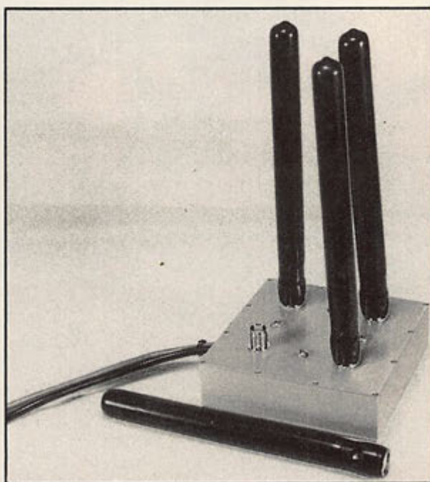
Le «sommateur HF» et les connecteurs antennes.
