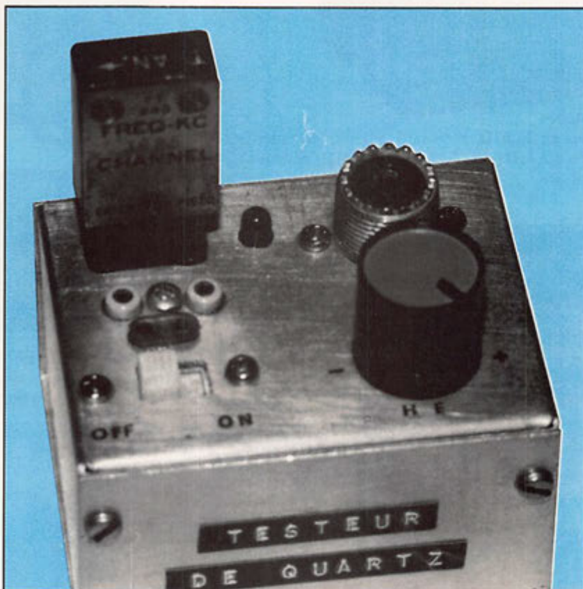
Vue générale de l'oscillateur/testeur de quartz fini. Sur cette photo, le quartz en cours d'essais est un FT243.
