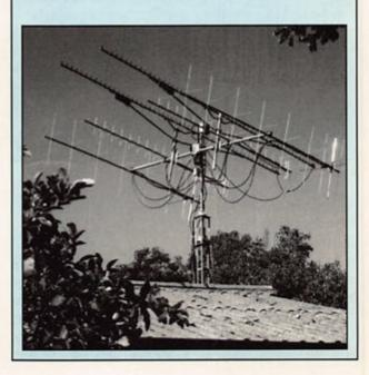
Pour les antennes, le choix est très large : une 2 x 9 el. croisés pour la bande 144 MHz et une 2 x 19 el. croisés sur 70 cm. Sur ces deux bandes, c'est la polarisation circulaire droite, créée par déphasage, qui est utilisée. Sur la bande 1200 MHz, l'antenne est une 2 x 55 éléments en polarisation linéaire.
