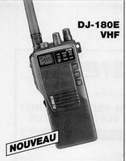
Emetteur-récepteur 144-146 MHz, FM • Sortie 2 W sous 7,2 V ou 5 W sous 12 V . Pas de 5/ 10/12,5/15/20/25 kHz • 10 mémoires avec paramètres dont une prioritaire • Scanning mémoires et bande VFO • Appel 1750 Hz et shift répéteurs . Arrêt automatique, beeper on/ off et éclairage afficheur . Alimentation 5,5 à 13,8 Vdc • Dimensions : 132 x 58 x 33 mm avec EBP-26N • Poids: 350 g • En option: extensions 50 et 200 mémoires, CTCSS.
