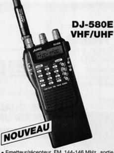
Emetteur/récepteur FM 144-146 MHz, sortie 0,3/2 W et 430-440 MHz, sortie 0,3/1,5 W avec EBP-20N, 5 W avec EBP-22N en option • Duplex-simplex + duplex intégral VHF/UHF • Réception et affichage LCD simultanés VHF/UHF 40 mémoires mixables VHF/UHF + 2 mémoires d'appel • Pas de 5/10/12,5/20/25 kHz · Scanning multi-fonctions · Appel 1750 Hz . DTMF et CTCSS . Identificateur d'appel des correspondants . Alimentation 7,2 à 12 Vdc • Dimensions: 140 x 58 x 33 mm • Poids:
