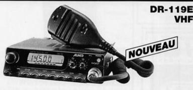
Emetteur-récepteur 144-146 MHz, FM • Sortie 5/50 W • Pas de 5/10/12,5/15/20 kHz • 14 mémoires avec paramètres • Scanning multifonctions • Appel 1750 Hz et shift 600 kHz et programmable Alimentation 13,8 Vdc • Dimensions: 140 x 40 x 170 mm • Poids: 1,1 kg
