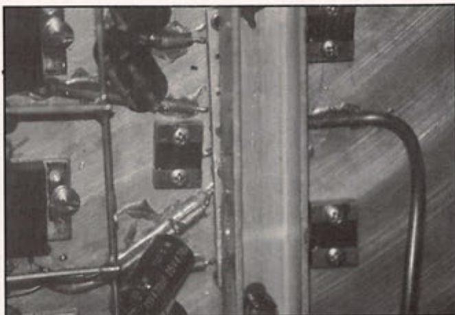
Photo 4 - Détail du coupleur de sortie. Noter que les résistances d'équilibrage sont de plus grande taille qu'à l'entrée !
