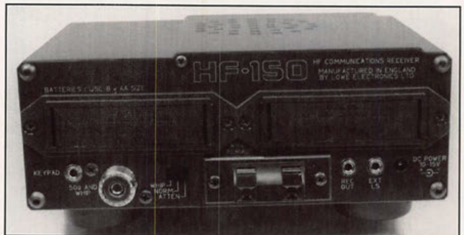
La face arrière : ses prises et tiroirs à piles.
