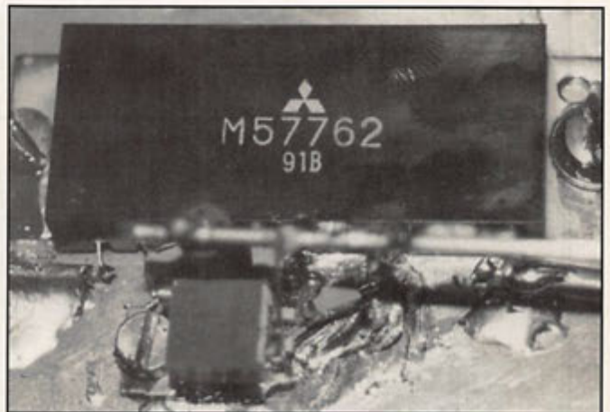
Photo 3 - Gros plan sur le câblage d'un hybride.
