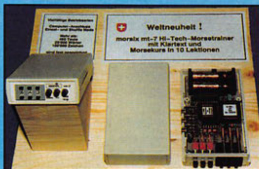
Un générateur de code et de texte en clair, pour apprendre la CW
