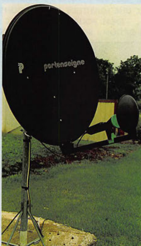
Parabole dite "grégorienne". Le rendement est amélioré par ce système.
