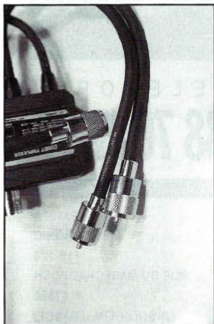
Les PL 259 utilisées, du matériel solide
