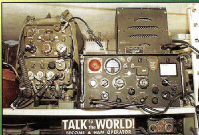
A gauche : VRC-7 : RT-70/GRC + AM-65/GRC + MT-300/GRC : 50 MHz FM. A droite : ARC-2 (2 à 5 MHz CW/AM). Dessus l'ARC : ampli AM-215 (15 W de 26 à 72 MHz FM), haut-parleur LS-3.
