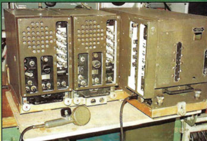
Ensemble SCR-608 pour char sur mounting en L : 29 MHz FM.
