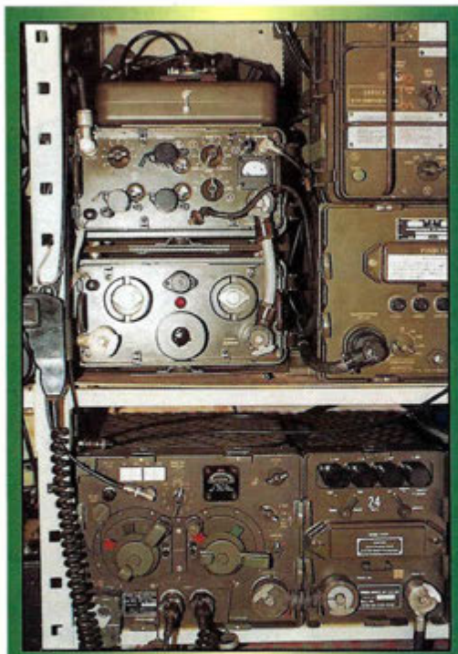
En bas : alim PP-112/GR + émetteur/récepteur RT-67/GRC : 29 MHz FM. En haut à gauche : ampli LV-80/GRC-9 : 100 W, 2-12 MHz. A droite : alim DY-88/GRC-9 avec au-dessus RT-77/GRC-9.
