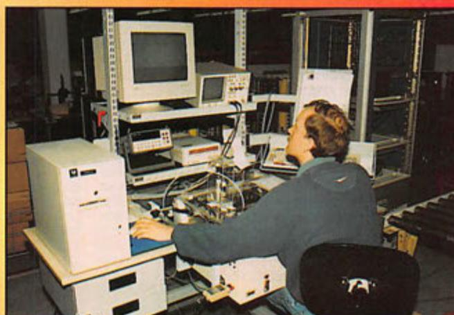
Banc de test fonctionnel pour électronique de plaques de cuisson « vitro céramique »..
