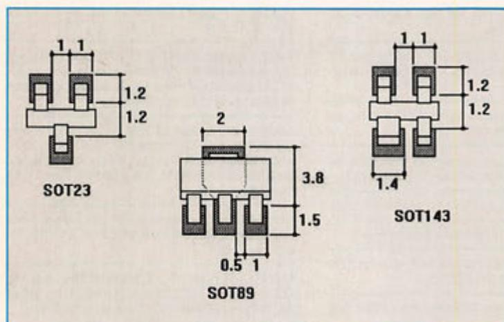
Figure 6b : Dimensions des pastilles des SOTs.
