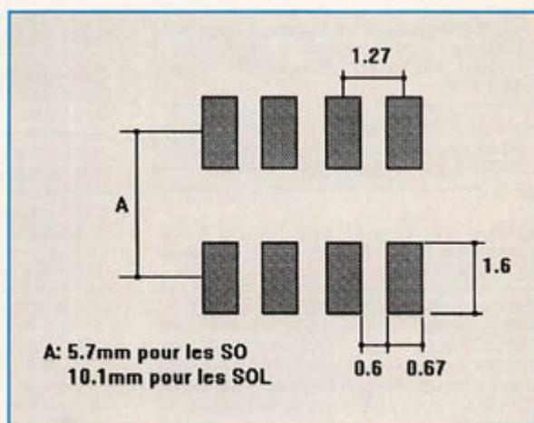
Fig. 6c : Dimensions des pastilles des SOIC.
