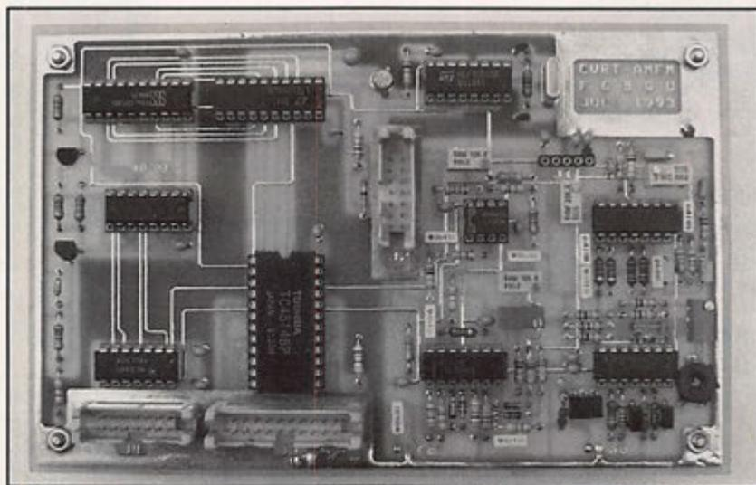
sous-porteuse du satellite (2400 Hz). Le reste est sans grand changement, sauf l'alimentation qui est parfaitement symétrique, ainsi que l'utilisation d'amplisop aux performances nettement supérieures. La partie émission (schéma 6) est un filtre passe-bas coupant les harmoniques engendrées par les signaux BF du haut-parleur de l'ordinateur (ceux-ci sont plutôt carrés que sinusoidaux).
