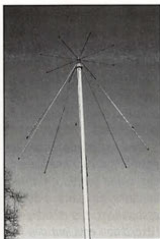
Antenne discône CTE
