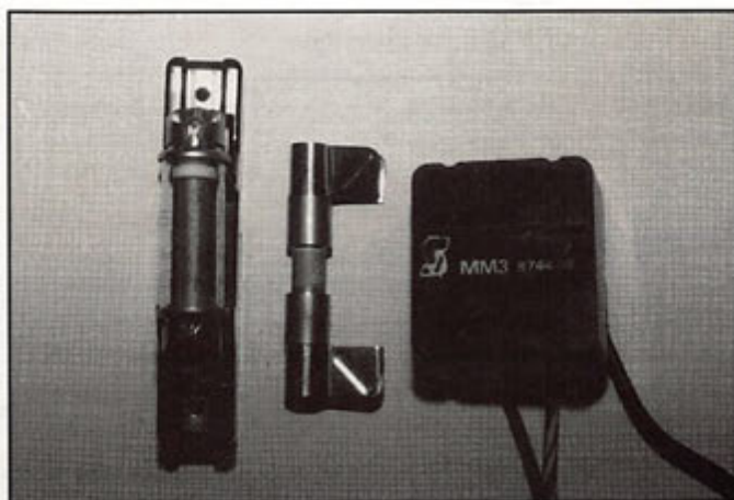
Photo B : A gauche : Parafoudre ancien modèle au centre : Parafoudre nouvelle norme à droite : Parafoudre 800 V
