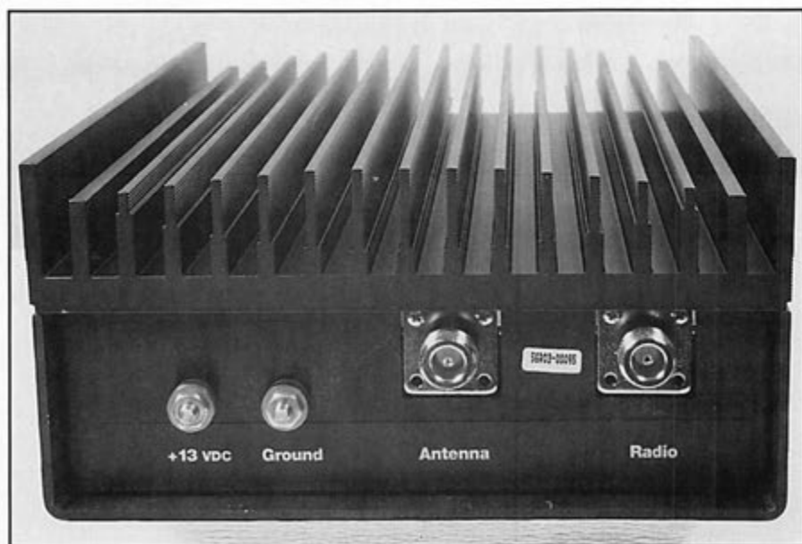
Entrée et sortie uniques : un duplexeur est nécessaire avant l'ampli.
