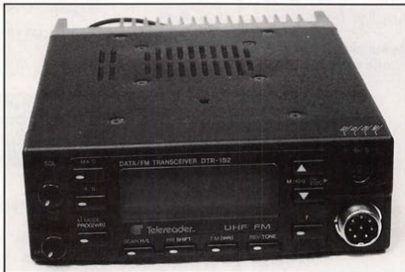
Le TNC et le transceiver ne font qu'un.
