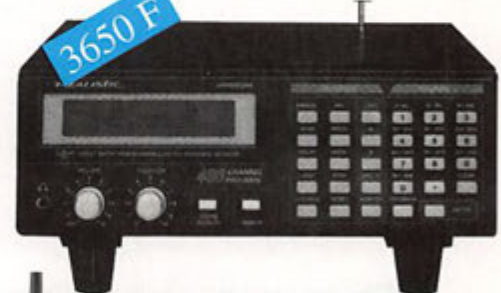
PRO 2006 REALISTIC 500 KHZ à 600 MHz 800 MHz à 1,3 GHz
