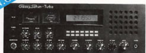
BASE SATURN TURBO Déca 28 MHz
