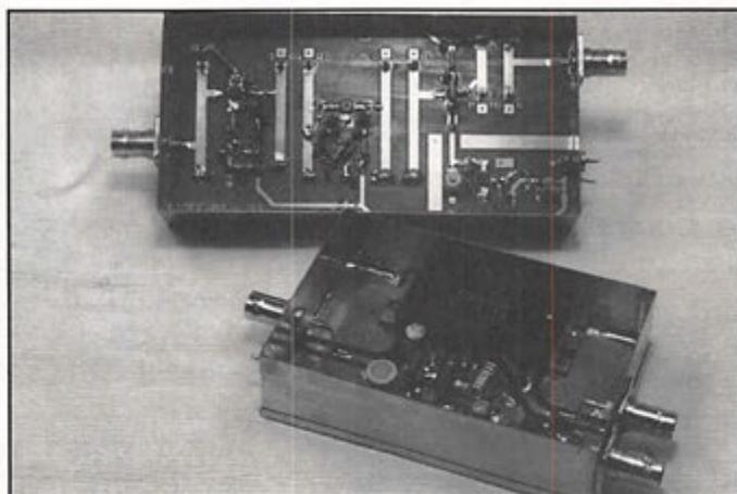
d'épaisseur 12/10. Cette pièce réalise le contact de masse entre le socle en cuivre du S-AU4 et le circuit imprimé. En outre, elle établit le contact thermique avec le radiateur.
