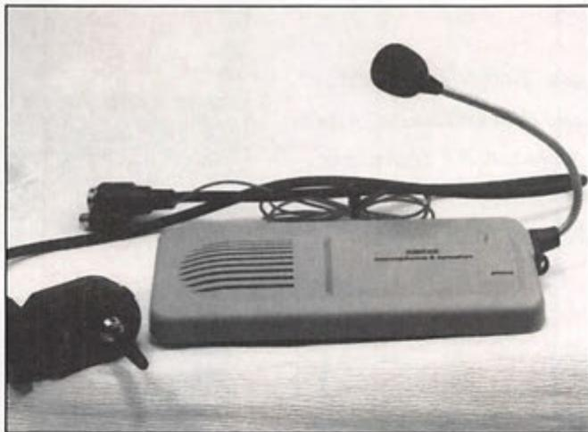
lequel est monté un micro (col de cygne). Le passage d'émission en réception est commandé par un interrupteur à fixer où bon vous semble, l'emplacement le plus indiqué étant le levier de changement de vitesses.
