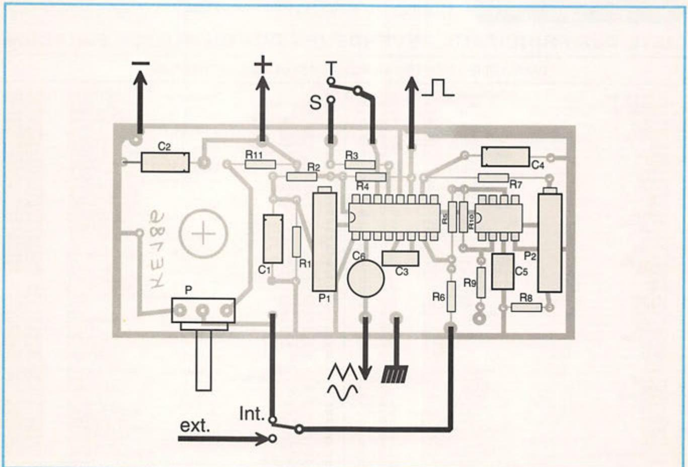
**Figure 5. Le dessin du circuit imprimé (mylar, échelle 1).**
