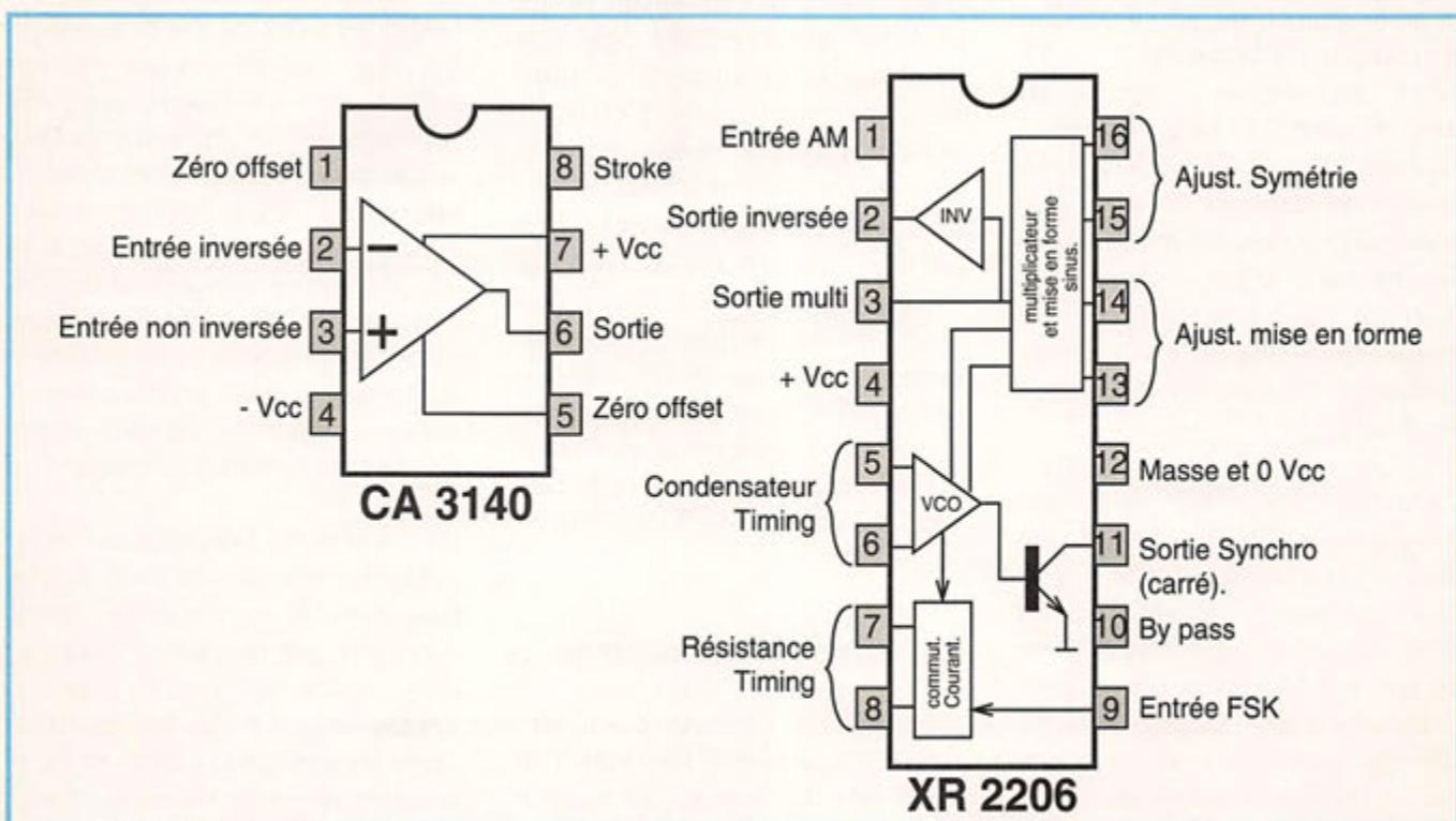
*Figure 1. Brochage des circuits intégrés (vue de dessus)*
