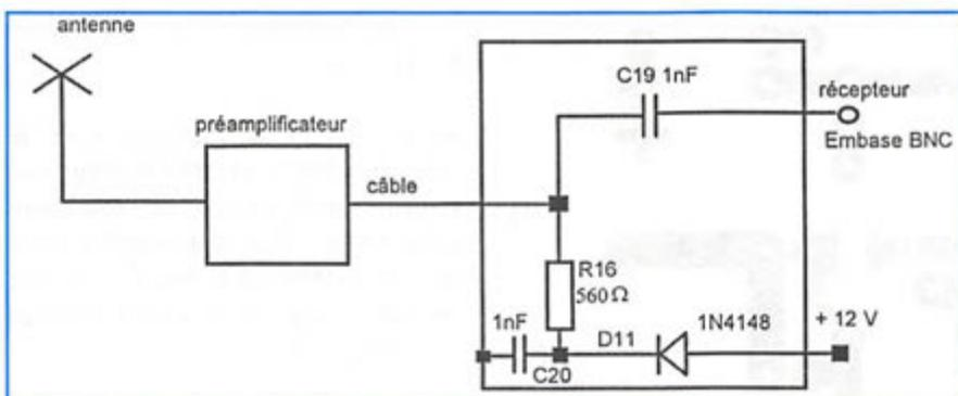
Le condensateur C19 bloque la composante continue vers le récepteur. La résistance R16 remplace R14 et R15. D11 protège contre les inversions de polarités de l'alimentation.
